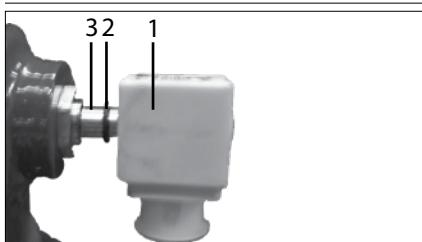
将带有垫圈(2)的卡接式线圈(1)放在压缩机的阀体(3)上。
