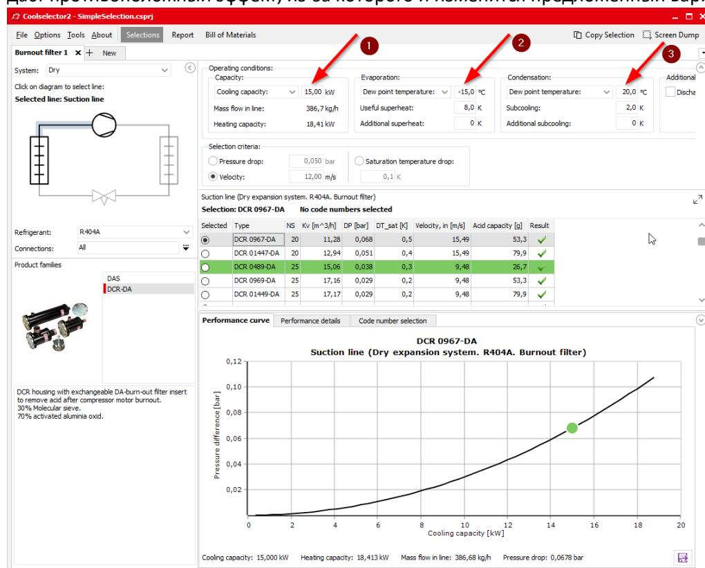
При изменении параметров системы на значения, указанные на приведенном выше рисунке, вместо фильтра DCR 0967-DA в качестве наиболее подходящего варианта Coolselector®2 предложит DCR 0489-DA.
