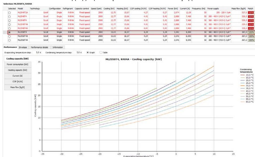
Предлагаемый компрессор удовлетворяет требованиям данного цикла и подходит по производительности. Вы можете проверить это по последнему столбцу, в котором указано соответствие компрессора заданным рабочим параметрам.
