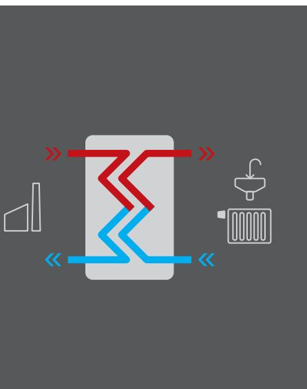
Теплопункт із незалежним підключенням використовується тоді, коли умови мережі централізованого теплопостачання, такі як тиск та температура, не дозволяють здійснити залежне підключення. У випадку теплопункту із незалежним підключенням енергоефективну теплопередачу забезпечує теплообмінник. Він також гарантує безпечне розділення первинної сторони теплової мережі та вторинної сторони будівлі.
