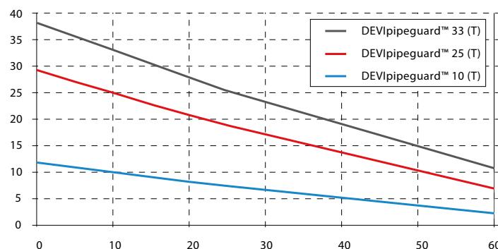
Effekten er målt på varmekabel installert på rør.
