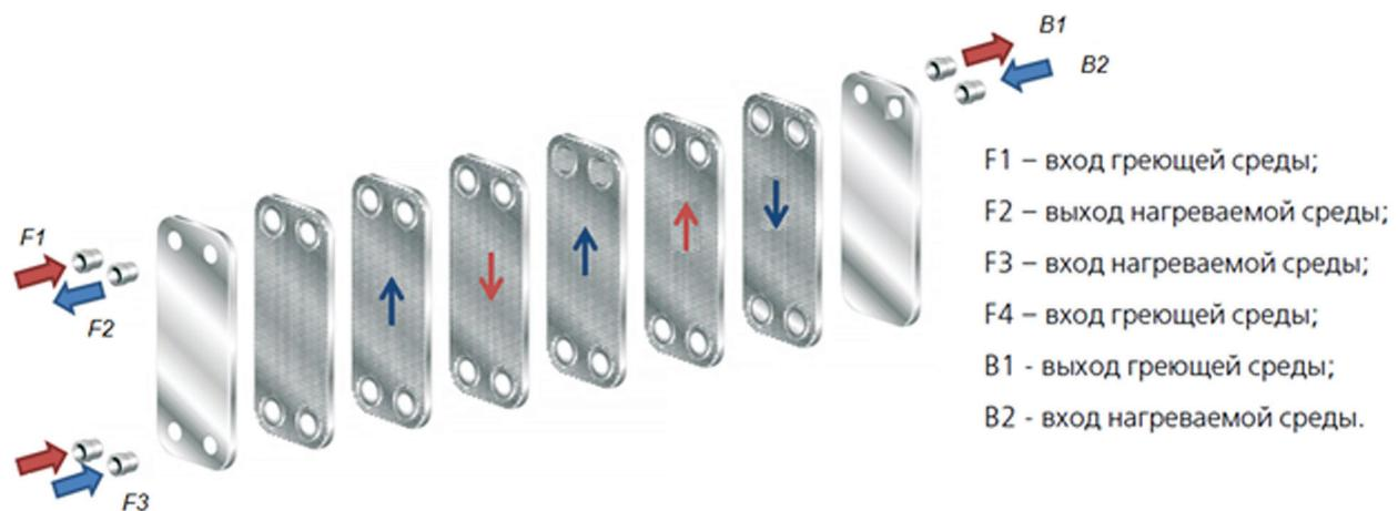
Рисунок A.4 — Пакет пластин и схема потоков рабочих сред в нем (двухходовая компоновка, моноблок)
