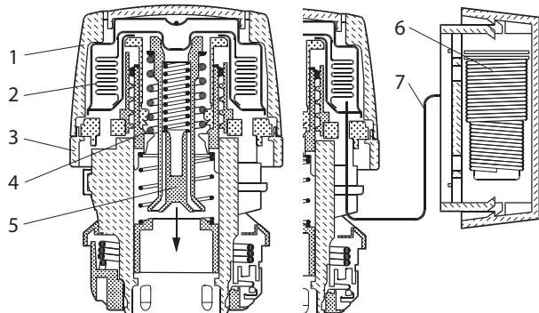
**Рис. 4.** Разрез терmostатического элемента RTR 7000: 1 – настроечная рукоятка; 2 – рабочий сильфон; 3 – шкала настройки; 4 – настроечная пружина; 5 – шток; 6 – выносной датчик; 7 – капиллярная трубка
