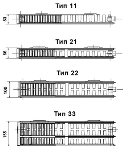
Рис. 6. Типы приборов в зависимости от количества панелей и П-образных поверхностей
