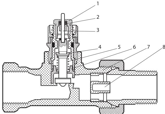
**Рис. 3.** Разрез клапана с преднастройкой типа RTR-N для двухтрубной системы: 1 – сальник; 2 – кольцевое уплотнение; 3 – нажимной штифт; 4 – уплотнение; 5 – возвратная пружина; 6 – дросселирующий цилиндр; 7 – корпус клапана; 8 – сопло
