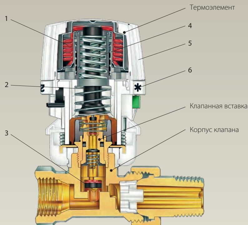
Рис. 2. Автоматический радиаторный терморегулятор: 1 — сильфон; 2 — шток; 3 — золотник; 4 — рабочая пружина; 5 — настроечная рукоятка; 6 — шкала настройки
