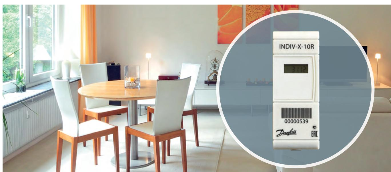
Датчик температуры отопительного прибора встроен в корпус распределителей INDIV-X. Температура воздуха запрограммирована как постоянная нормативная величина, равная 20 °C. Таким образом, приборы INDIV-X представляют собой распределители с одним датчиком температуры.
