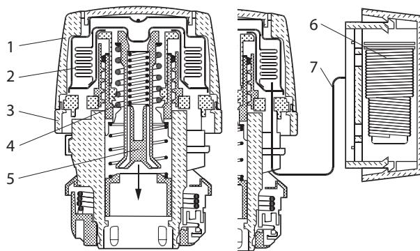
**Рис. 14.** Разрез терmostатического элемента типа RTR 7000
