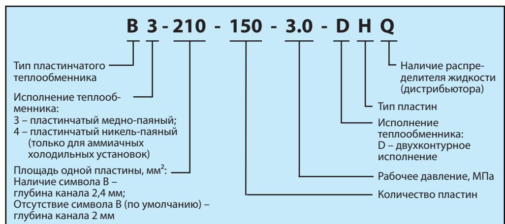
**Теплообменник пластинчатый паяный, модификация B-012**
