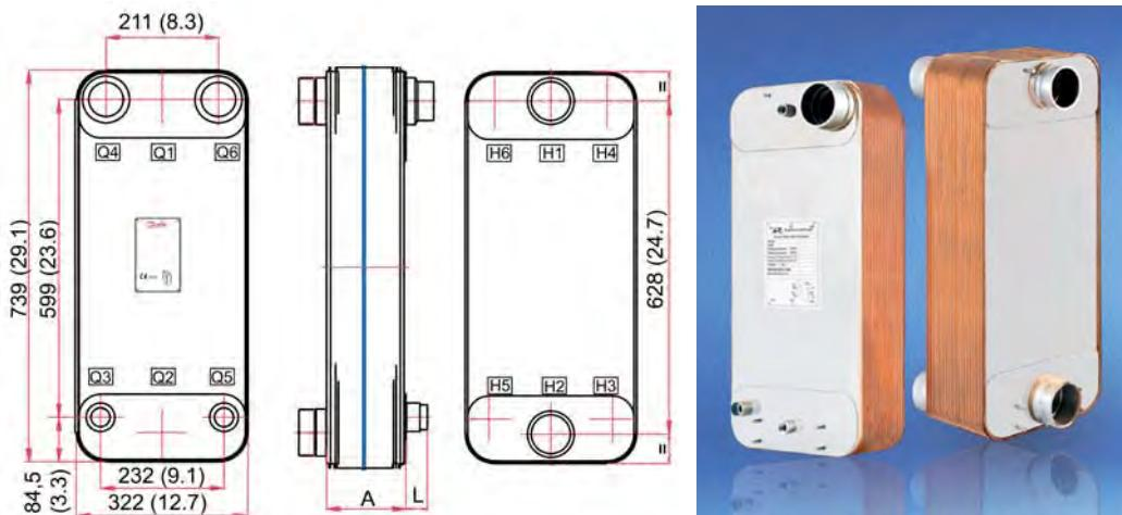
Габаритные размеры и изображение теплообменника пластинчатого паяного модификации В-210
