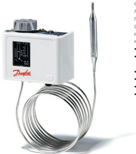
Реле температуры КР производства компании Danfoss используются для систем регулирования, контроля и аварийной сигнализации в промышленных установках. Реле температуры КР — это автоматические реле, положение контактов которого зависит от температуры контролируемой среды. Эти устройства снабжены однополюсным переключателем на два направления (SPDT) и могут непосредственно управлять работой однофазных двигателей переменного тока мощностью до 2 кВт.
