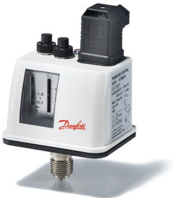
Серия ВСР предназначена для автоматизации и технологической защиты паровых и водогрейных котлов. Реле давления оснащено однополюсным перекидным контактом, который меняет положение в зависимости от соотношения давления среды и уставки. В случае ответственных применений рекомендуется использовать реле с функцией защиты.
