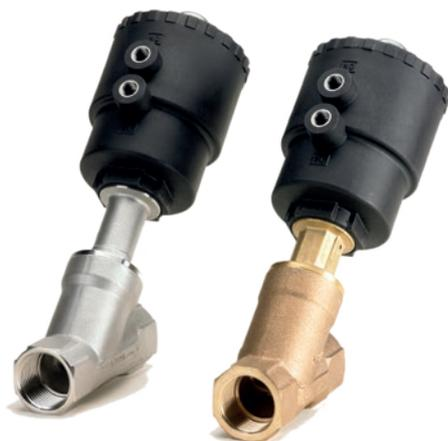
AV210 — угловые клапаны с пневматическим управлением, предназначенные для использования в жестких промышленных условиях. Клапаны могут работать при очень высоких температурах и значениях вязкости рабочей среды и нечувствительны к частицам грязи, содержащимся в этой среде. Клапаны выпускаются с корпусом из бронзы (RG5/бронза) или нержавеющей стали (AISI316).
