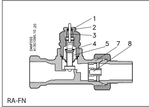
Le robinet thermostatique se compose d'un élément thermostatique de la série RA 2000 et d'un corps de vanne. Élément et corps de vanne se commandent séparément.
