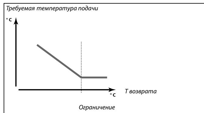
Пример: ограничение максимальной температуры обратки; температура обратки становится выше установленного предела
