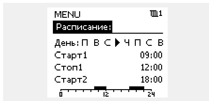
График показывает время начала и окончания комфорtnого периода (контур отопления и контур ГВС) для каждого дня недели.
