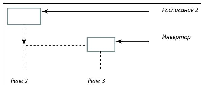
В соответствии с заводскими настройками расписание 2 меняется каждый 21 час в течение недели. Благодаря этому два циркуляционных насоса работают поочередно примерно одинаковое время.
