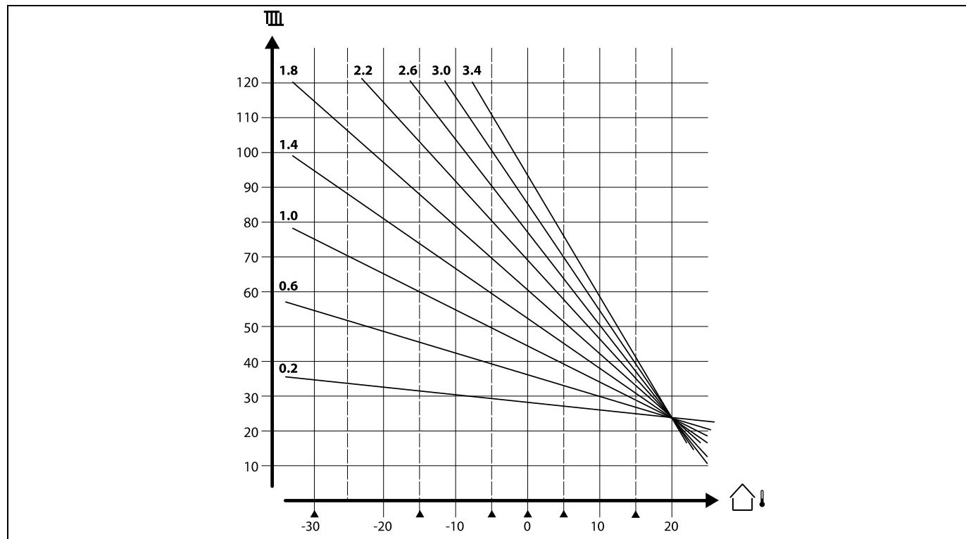
Небольшие стрелки ( $\blacktriangle$ ) отображают 6 разных значений температуры наружного воздуха, при которых можно менять отопительный график.
