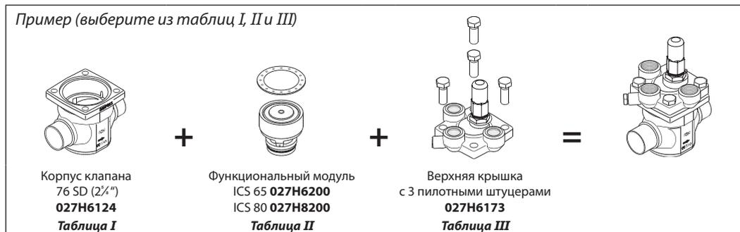
Корпус клапана ICS 65 с разными присоединительными штуцерами Таблица I
