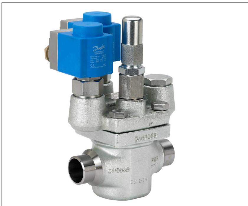
L'électrovanne ICSH à double position appartient à la gamme ICV et comporte un boîtier ICV, un insert ICS ainsi qu'un couvercle supérieur ICSH avec deux électrovannes pilotes EVM normalement fermées installées sur le couvercle supérieur.
