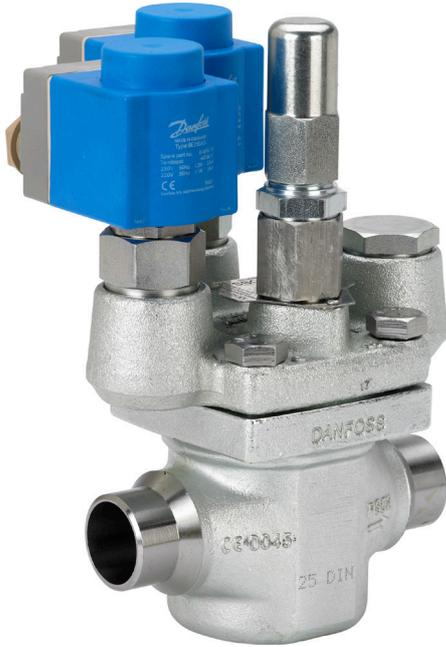
ICSH 双位电磁阀属于 ICV 产品系列之一，包含一个 ICV 阀体、一个 ICS 功能模块，以及一个配有 2 个 EVM 常闭电磁导阀的 ICSH 阀盖。
