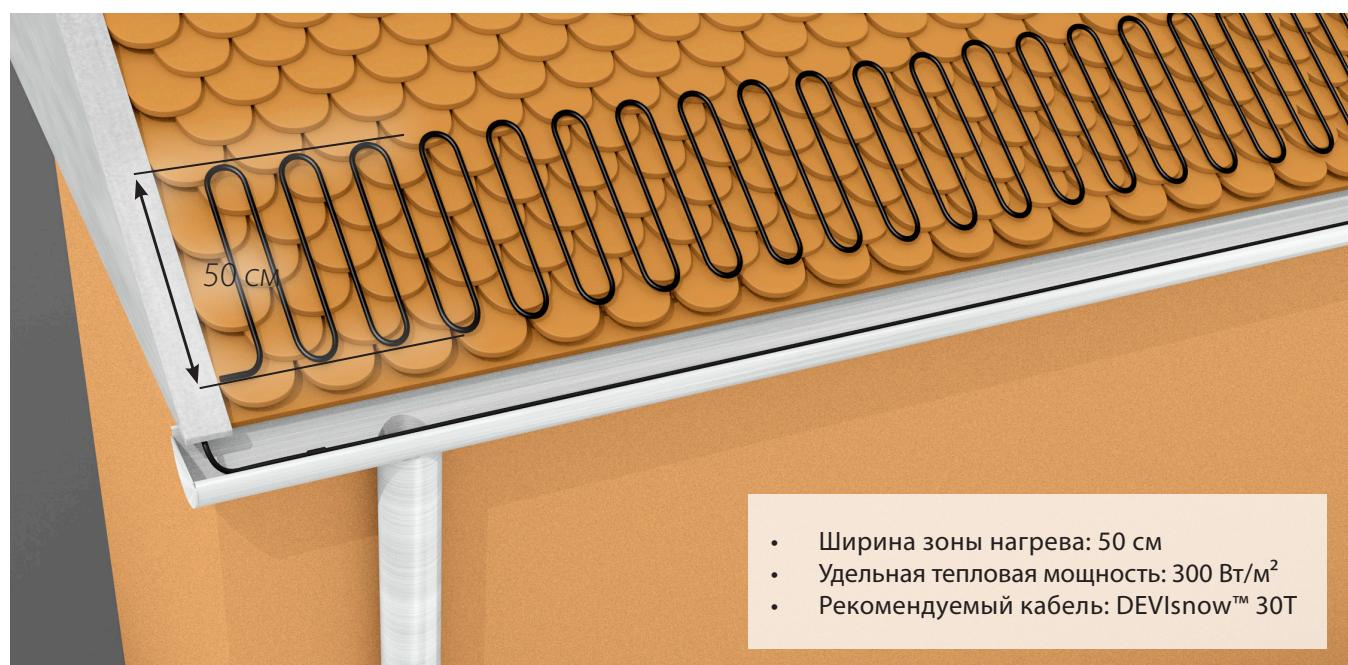
Края крыши и водосточные желоба с системой нагрева.
