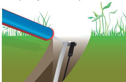
Після укладання блоків або заливання бетону/асфальту, встановіть зовнішній датчик(-и), а також подовжіть кабель(-и) датчика(-ів) відповідно до інструкції датчика.
