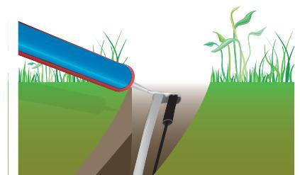
После укладки блоков или заливки бетона/асфальта установите наружный датчик(и) и удлините кабель (кабели) датчика в соответствии с инструкцией по использованию датчика.
