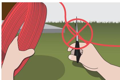
**Запрещается отрезать или укорачивать нагревательный элемент.**
