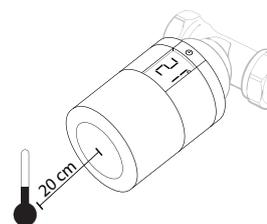
*Примечание. На дисплее всегда отображается установленная температура, а не фактическая температура в помещении.*
