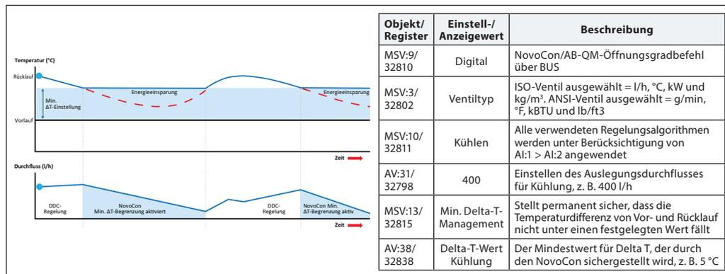
**Zustand 5: Eingestellte Delta-T Regelung (Beispiel Heizwasser)**
