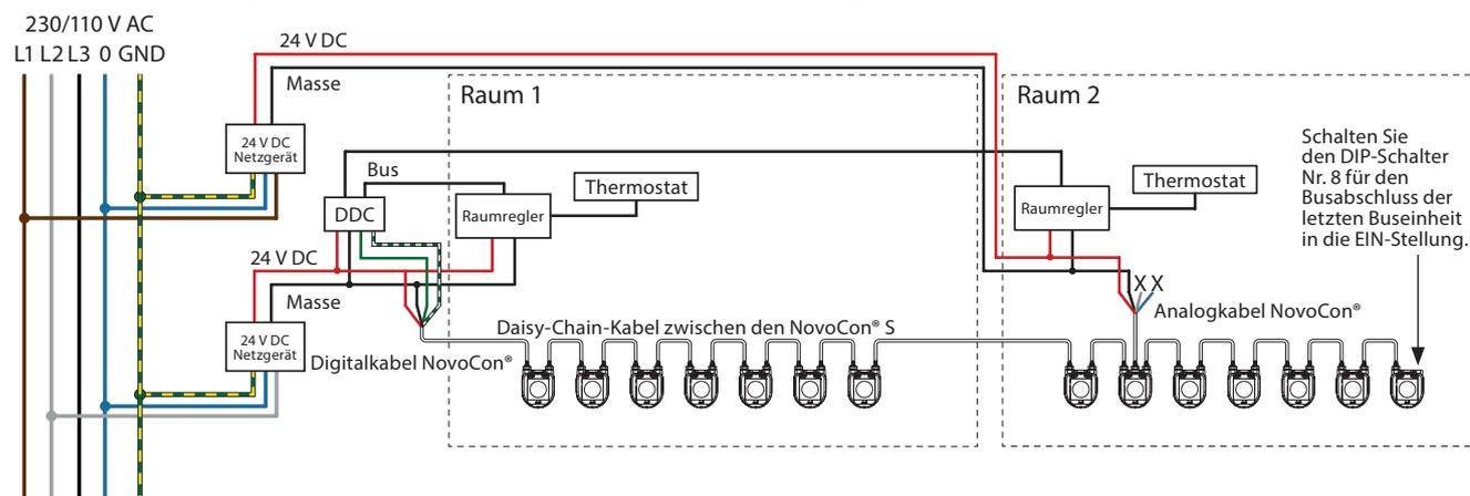
**Verdrahtung mit Gleich- oder Wechselspannungsversorgung:**
