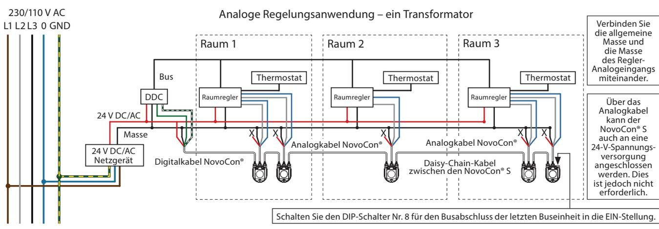
**Verdrahtung mit Wechselspannungsversorgung:**
