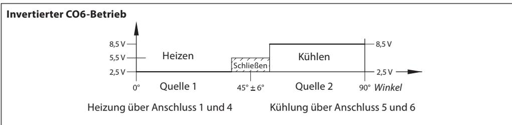
Signal vom NovoCon® S zum Stellantrieb NovoCon® ChangeOver®
