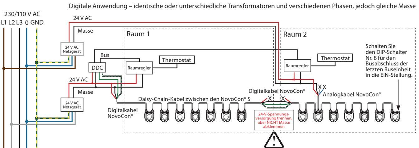
Kabel, die in einem „X“ enden, müssen ordnungsgemäß terminiert werden.
