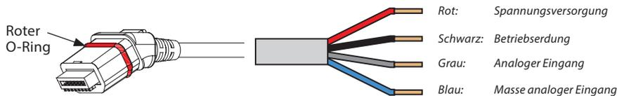
Das Analogkabel wird für den Anschluss an die Spannungsversorgung und für ein analoges Regelsignal verwendet. Das Analogkabel kann auch als ein Spannungsverstärker für den NovoCon® S im Netzwerk verwendet werden. „Betriebserdung“ und „Masse analoger Eingang“ sollten am Regler an denselben Masseanschluss angeschlossen werden.
