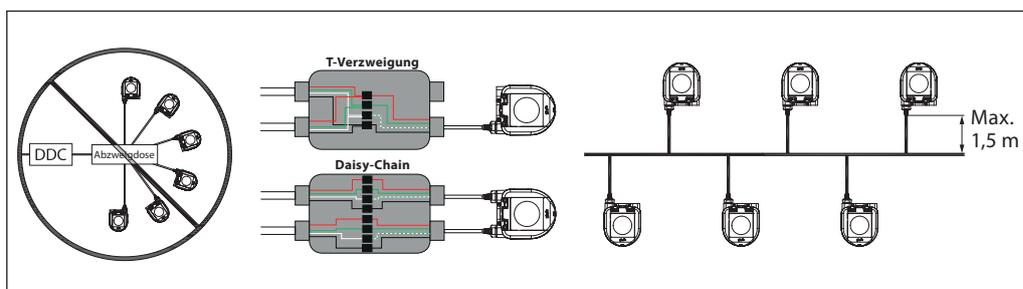
Wenn die Versorgungsspannung des ersten Geräts in der Daisy-Chain-Verkettung niedriger ist als 24 V AC/DC oder andere Kabel als die NovoCon®-Kabel verwendet werden, muss ggf. die Anzahl der Geräte in der Daisy-Chain-Verkettung verringert werden.
