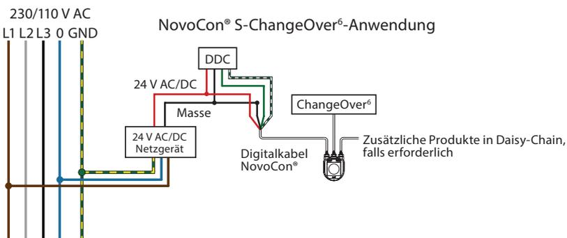
**Verdrahtung analoger CO6-Betrieb**
