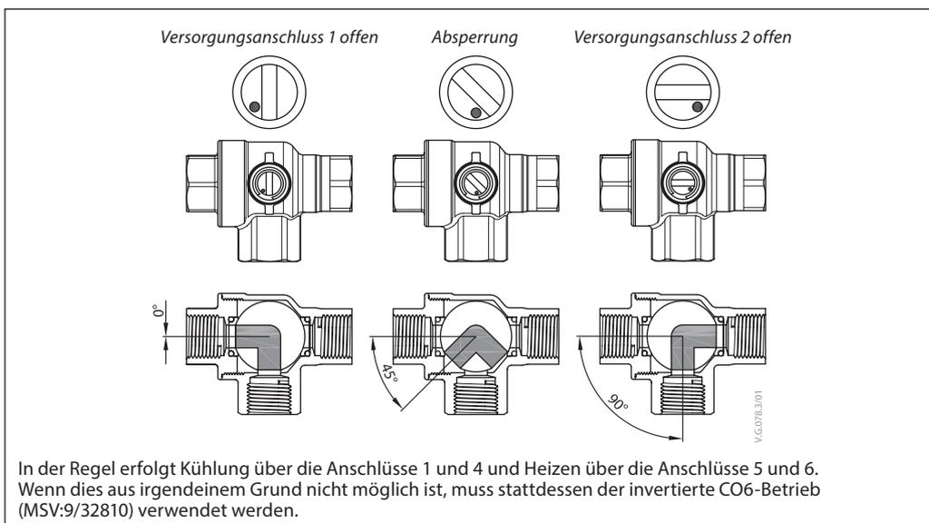
Das CO6-Ventil verfügt im Gegensatz zu anderen Kugelhähnen über eine Absperrfunktion. Diese sollte nur bei Wartungsarbeiten und nicht im Betrieb eingesetzt werden. Durch diese Funktion sind keine vier Kugelhähne erforderlich. Der Absperrbefehl kann nur ausgeführt werden, wenn der Volumenstrom-Sollwert (AV:1/33280) = 0 ist.
