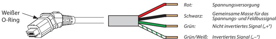
Das Digitalkabel wird verwendet, um den Stellantrieb NovoCon® an andere BACnet-/Modbus-Geräte anzuschließen. Es wird darüber hinaus verwendet, um den NovoCon an ein längeres Netz-/Kommunikationskabel, das keine standardmäßigen Vertriebsnummern hat, anzuschließen.
