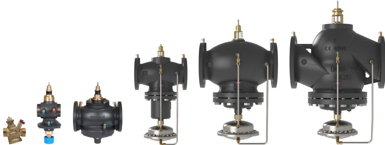
Ventil AB-QM sa pogonom predstavlja regulacioni ventil sa punim autoritetom i automatskom balansnom funkcijom/ograničenjem protoka. Tipične primene su: Regulacija temperature i stalno automatsko balansiranje priključenih uređaja (klima komore, ventilator konvektori, indukpcioni uređaji, rashladne tavanice, razmenjivači topline itd.). Verzija bez pogona ima ulogu ograničivača protoka, na primer, za jednocevne sisteme.
