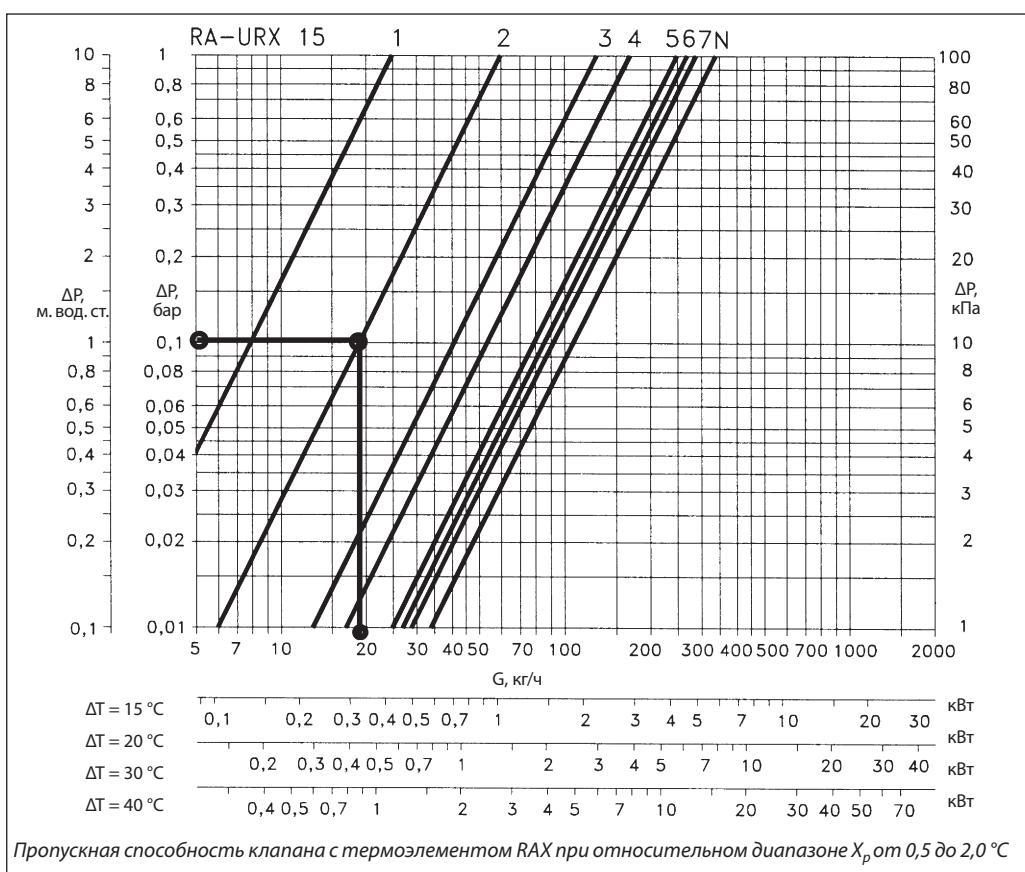
Пропускная способность клапана с термоэлементом RAX при относительном диапазоне  $X_p$  от 0,5 до 2,0 °C
