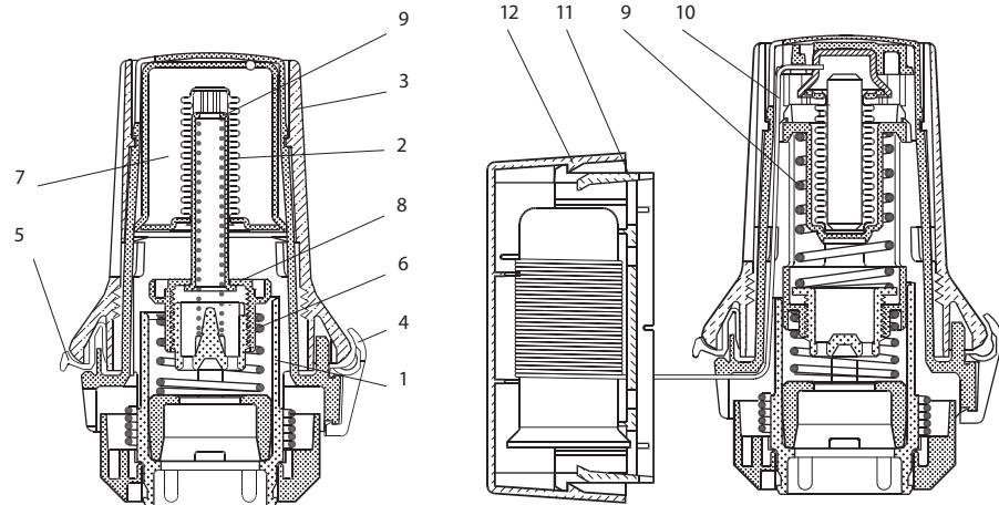
*a — со встроенным датчиком**б — с выносным датчиком*
