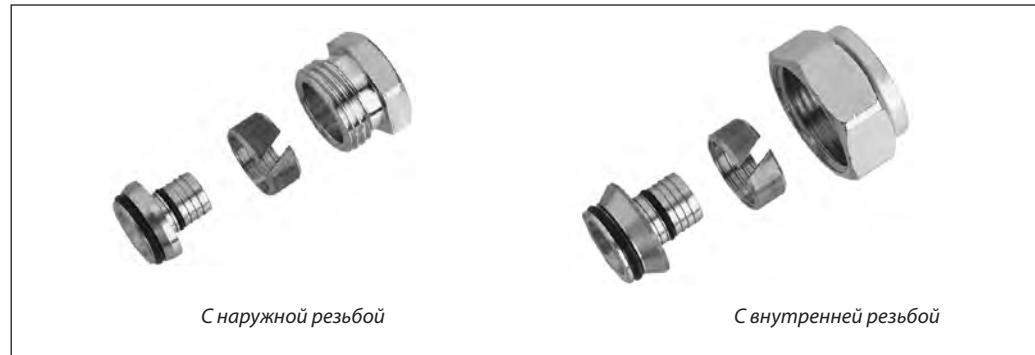
Уплотнительные фитинги предназначены для соединения клапанов терморегуляторов Danfoss и запорно-присоединительных элементов с трубопроводами систем отопления. Они применяются при использовании в системах отопления полимерных труб типа PEX, изготавливаемых в соответствии со стандартом DIN 16892/16893.
