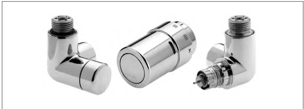
Терморегулирующий комплект X-tra™ специально разработан для полотенцесушителей. Он состоит из клапана терморегулятора, терmostатического элемента и запорного клапана с дренажной функцией. Инновационное самоуплотняющееся присоединение клапанов к радиатору осуществляется с помощью резьбы  $\frac{1}{2}$ ".
