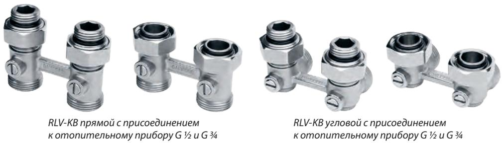
Клапан запорно-присоединительный RLV-KB предназначен для подключения к двухтрубным горизонтальным системам отопления отопительных приборов с нижними присоединительными штуцерами при их межосевом расстоянии 50 мм. Клапан RLV-KB не подходит для присоединения к нему спускного крана.
