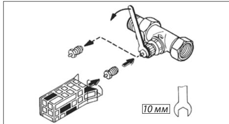
**Адаптер для присоединения термостатических элементов RA 5062, RA 5065 и RA 5068 к клапанам терморегуляторов с установочной резьбой M30 x 1,5**
