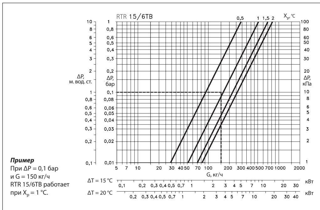
**Рекомендации по использованию присоединительно-регулирующей гарнитуры в однотрубной системе отопления**
