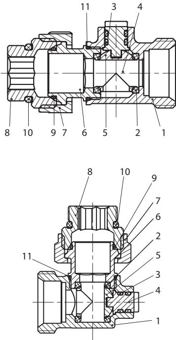
Устройство клапана RLV-KB
