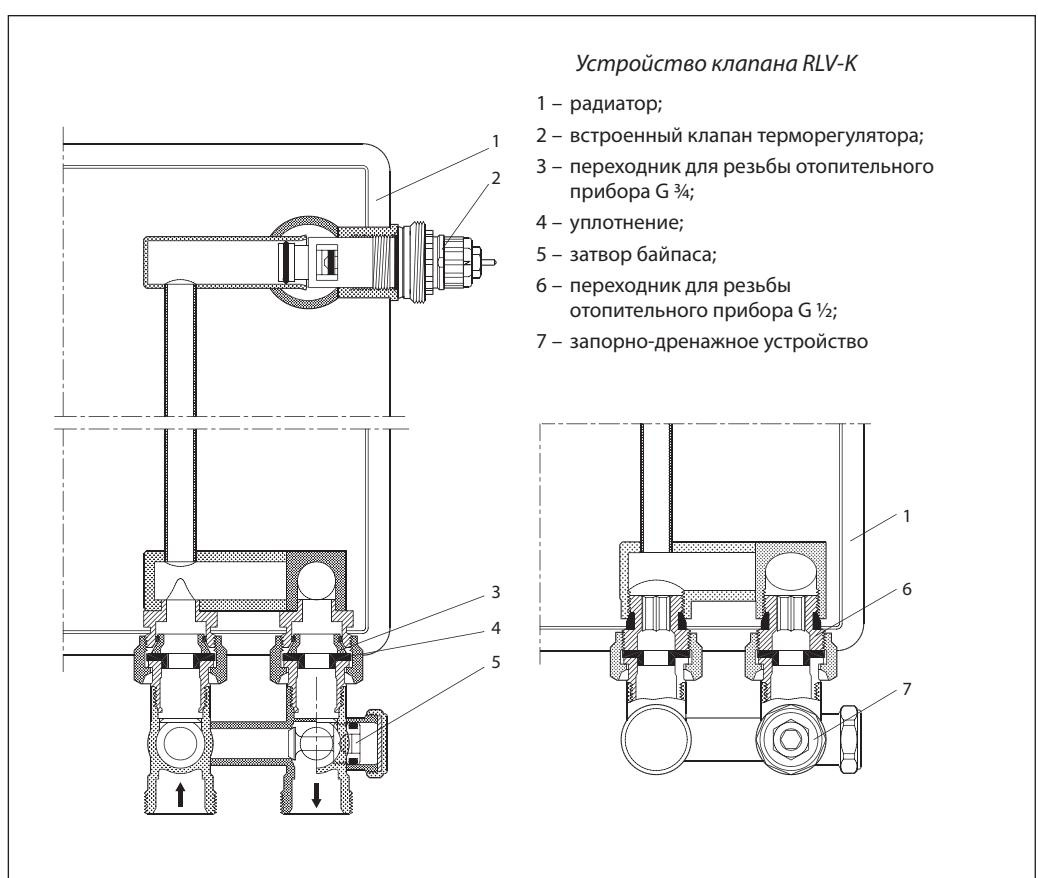
*Устройство клапана RLV-K*
