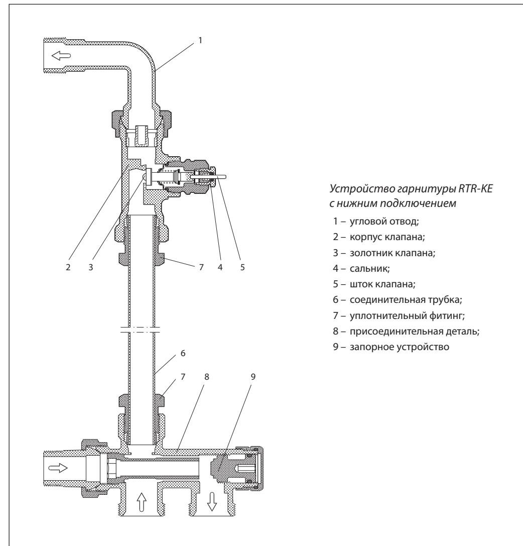
*Устройство гарнитуры RTR-KE с нижним подключением*
