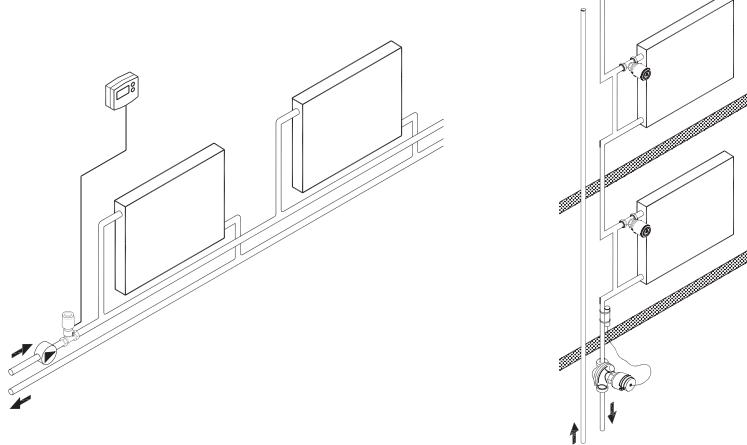
*а — горизонтальная двухтрубная система с электроуправляемым зональным терморегулятором (клапан RTR-G в комбинации с приводом TWA и комнатным термостатом)*
