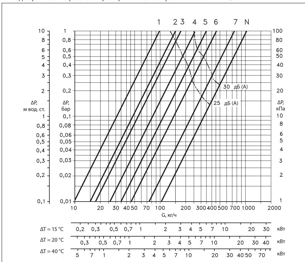
**Определение предварительной настройки клапанов RTR-N и RA-NCX (продолжение)**
