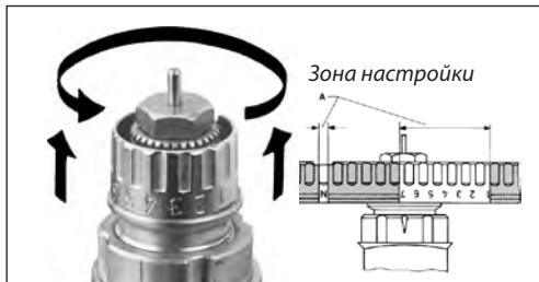
На настроочном устройстве клапана указаны положения настройки от «1» до «7» и буква «N». Настройка может быть выполнена быстро и точно без применения какого-либо инструмента, для этого необходимо:
