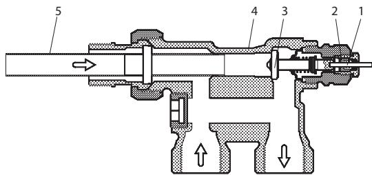
RTR 15/6T для однотрубной системы отопления
