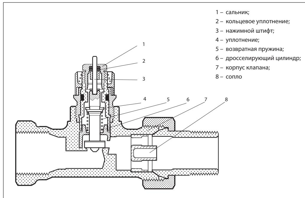
Радиаторный терморегулятор состоит из двух частей: универсального термостатического элемента серии RTR и регулирующего клапана с предварительной настройкой RTR-N. Термостатический элемент и регулирующий клапан заказываются отдельно.
