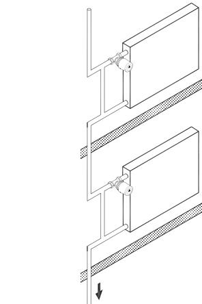
*Однотрубная система отопления с терморегуляторами*
