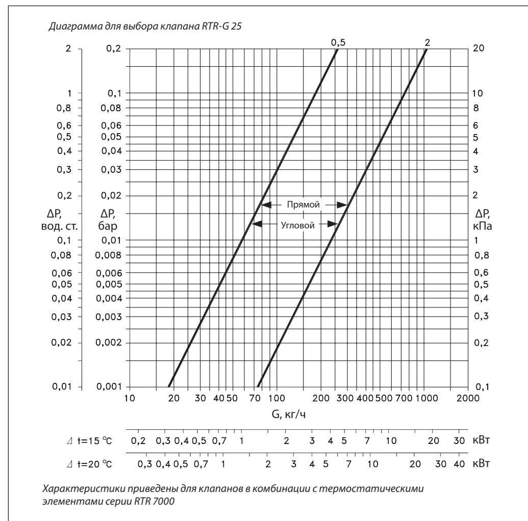
**Пример выбора регулирующего клапана RTR-G**
