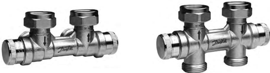
Клапан запорно-присоединительный RLV-KDV предназначен для нижнего подключения радиатора в горизонтальных двухтрубных системах. Клапан изготавливается из латуни с никелевым покрытием в прямом и угловом исполнениях. RLV-KDV обладает следующими функциональными возможностями:
