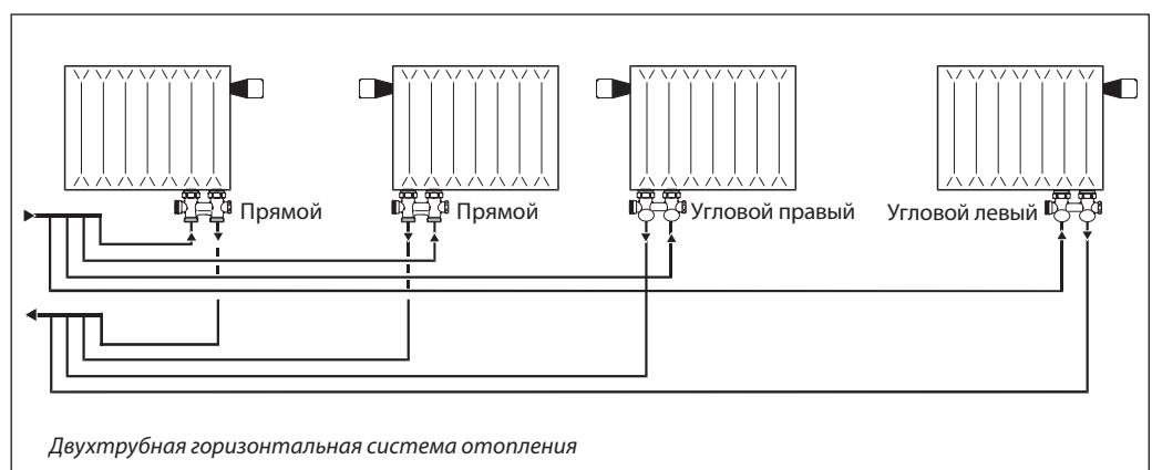
**Важно!** Для угловых клапанов правое и левое исполнение выбирается исходя из положения подающего патрубка. Правое исполнение – подающий патрубок справа, левое исполнение – подающий патрубок слева, стрелками на корпусе указано направление движения теплоносителя. Поток теплоносителя против стрелки недопустим.
