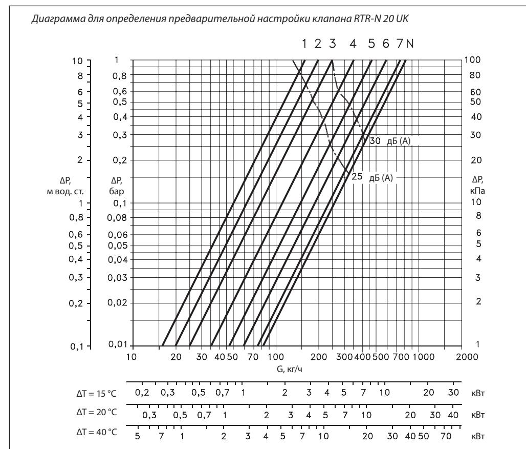
**Пример определения настройки клапана RTR-N**
