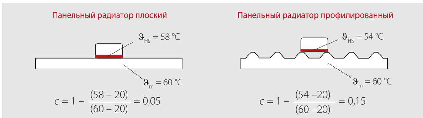
Рис. 1. Зависимость величины  $c$  от степени контакта задней стенки распределителя с поверхностью радиатора
