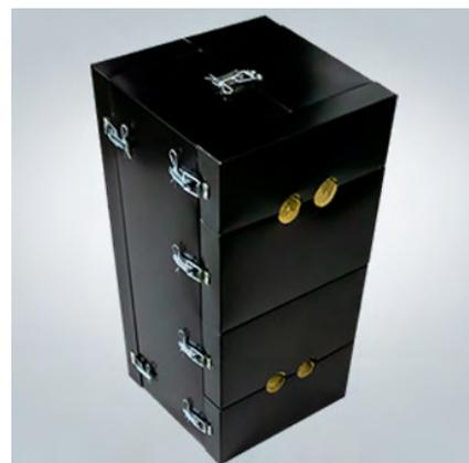
Теплоизоляционные кожухи «Ридан» отличаются превосходными эксплуатационными характеристиками. Алюминиевая подложка у внутреннего слоя минеральной ваты исключает риск загрязнений от изоляционного слоя из каменной ваты на пакете пластин и гарантирует долговечность изоляции. Быстроразъемные замки предназначены для многократного использования, и в случае необходимости обслуживания и разборки аппарата они легко снимаются и устанавливаются обратно.
