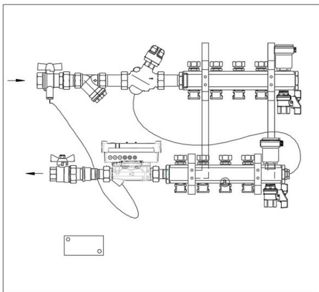
Шкаф с узлом присоединения квартирной системы отопления типа ШКСО-1 предназначен для подключения к двухтрубной горизонтальной системе отопления. ШКСО-1 на 1 отвод для подключения к системе отопления с периметральной разводкой, ШКСО-1 на 2 и более отводов для подключения к системе отопления с лучевой разводкой. При применении шкафов с узлами присоединения квартирной системы отопления типа ШКСО-1 выполняются присоединительная, измерительная, регулирующая и распределительная функции.
