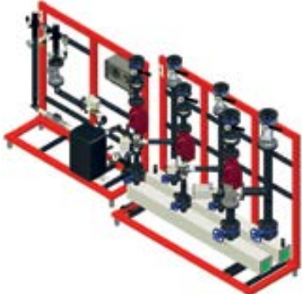
DSE I1B (H3 bzw. H2WS) Indirekte Fernwärmeübergabestation mit 3 Sekundärheizkreisen zum Anschluss der Hausheizung und optional der Trinkwassererwärmung mit insgesamt 3 Regelkreisen
