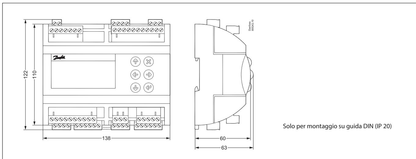
Solo per montaggio su guida DIN (IP 20)
