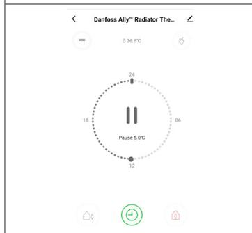
Quando Danfoss Ally™ viene portato manualmente al livello Min, viene visualizzata una notifica e l'icona centrale mostra il simbolo “Pause”.
