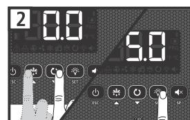
**IMPORTANTE:** El asistente de configuración se activa solamente cuando el controlador se conecta por primera vez. Para activarlo de nuevo, se debe activar el modo Stand-By presionando el botón **↓** durante 3 segundos y esperar a que el equipo detenga la regulación completamente (El indicador **↓** se ilumina de forma permanente) y a continuación pulsar en este orden las botones: **▲**, **▼**, **SET**.
