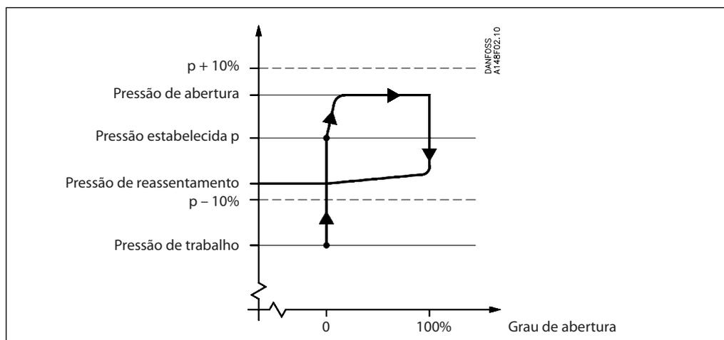
A SFA é projetada como uma válvula de segurança de carga direta, recomendada especialmente para aplicações de refrigeração. Ao sofrer um aumento de pressão acima da pressão de ajuste, a válvula de alívio de segurança começará a abrir ligeiramente para minimizar a saída do refrigerante. Se a pressão
