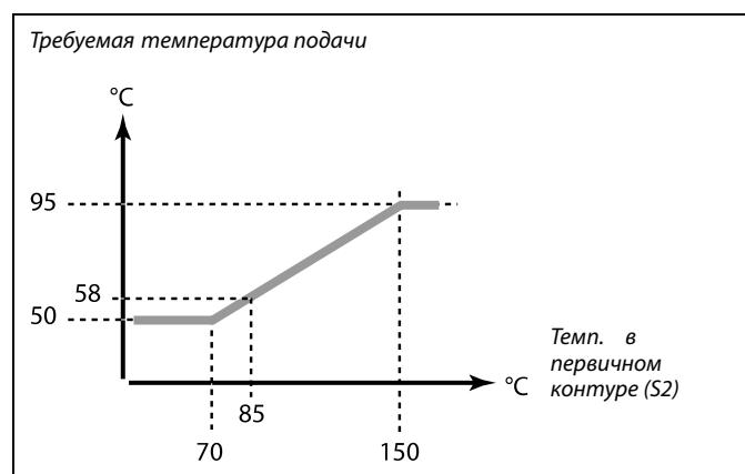
⚠️ Вышеприведенный график является примером температуры первичного контура (S2)  $85^{\circ}\text{C}$ . Требуемая температура подачи ( $58^{\circ}\text{C}$ ) основана на настройке отношения между температурой первичного контура (S2) и требуемой температурой подачи.
