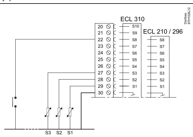
Пример, реле блокировки автоматического управления подключено к S8:
