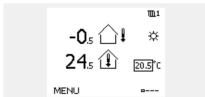
На обзорном дисплее отображается температура наружного воздуха, текущая и требуемая комнатная температура.
