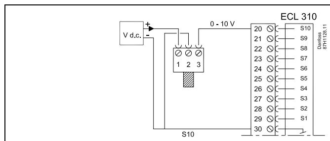
**Подключение реле давления, S8**
