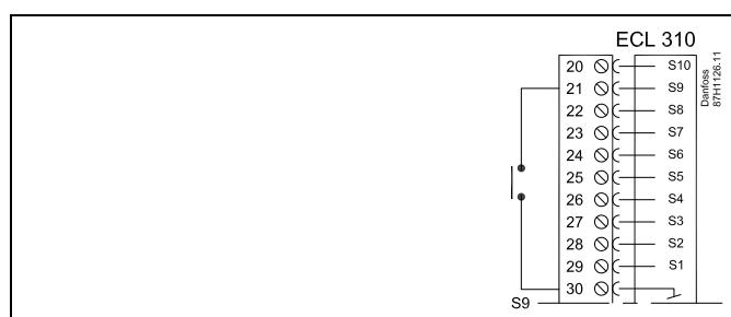
Сечение провода для присоединения датчика: Мин. 0.4 мм<sup>2</sup>.
