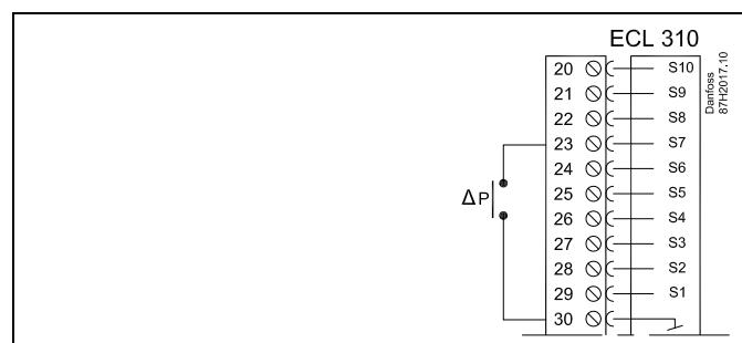
**Подключение преобразователя давления с выходом
