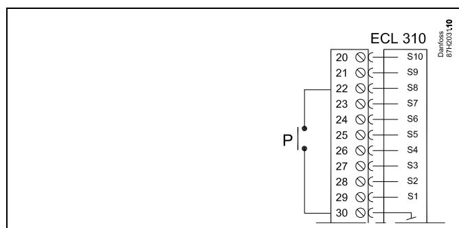
**Подключение датчика сигнализации S9**
