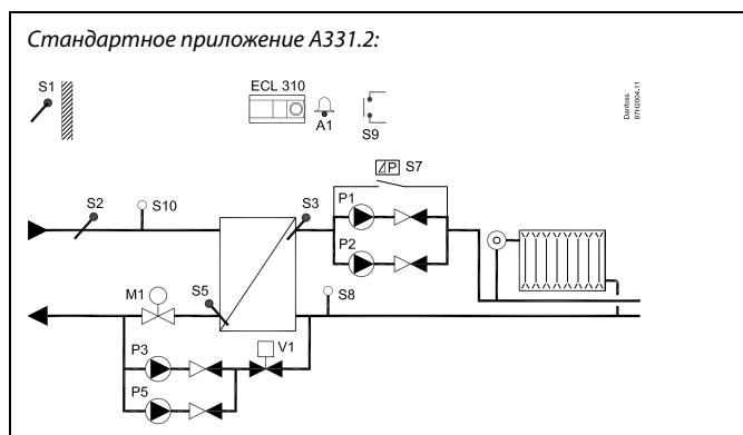
Возможна установка связи с системой SCADA по шине Modbus.
