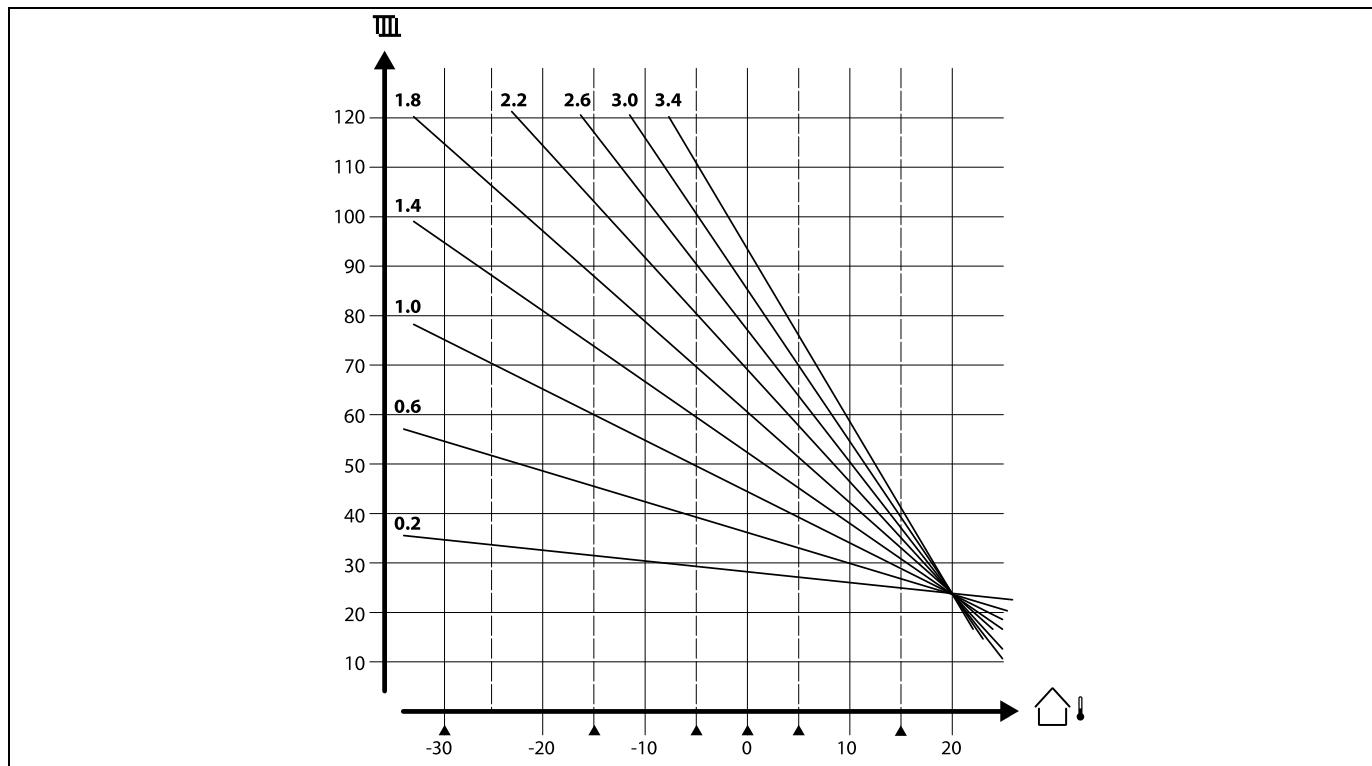
Небольшие стрелки (▲) отображают 6 разных значений температуры наружного воздуха, при которых можно менять отопительный график.
