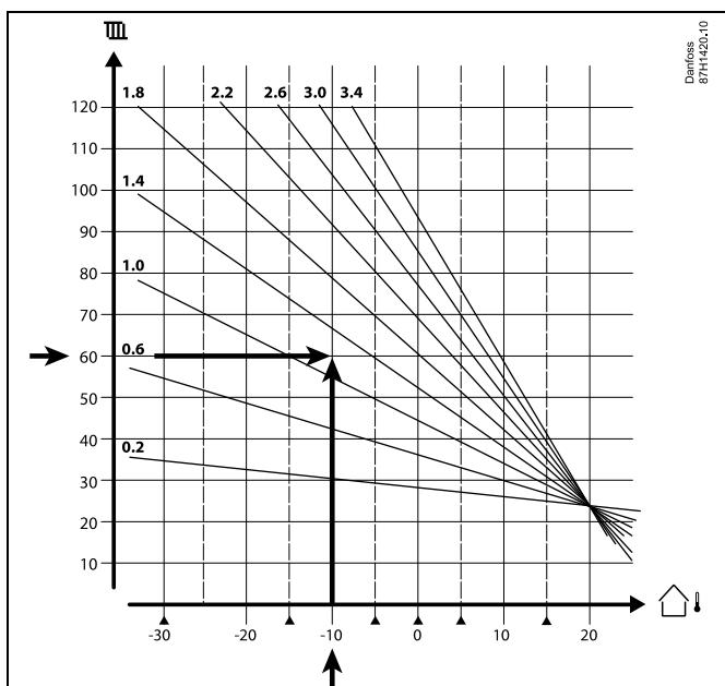
Выберите требуемую температуру подачи (вертикальная ось) для вашей отопительной системы при ожидаемой максимально низкой температуре наружного воздуха (горизонтальная ось) для вашей области. Выберите график, который ближе всего с общей точке данных двух значений.
