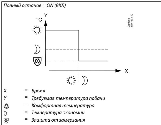
Минимальная температура подачи («Т мин.») отменяется, когда параметр «Полный останов» имеет значение ON (ВКЛ).
