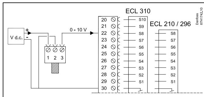
**Подключение преобразователя давления с выходом
