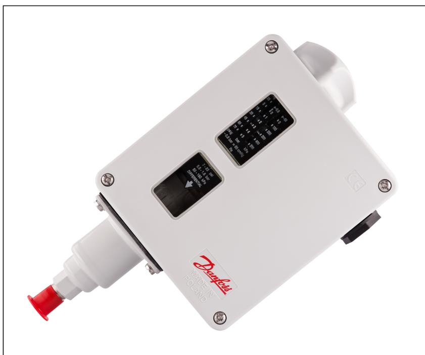
Реле давления RT содержит управляемый давлением однополюсный переключающий контакт, положение которого зависит от давления во входном штуцере и уставки по шкале.
