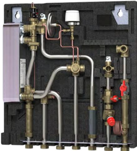
Zur Effizienzsteigerung bei Systemen mit Wärmepumpen wurde diese 4-Leiter Wohnungsstation entwickelt. Das Konzept beinhaltet die Nutzung zweier unterschiedlicher Temperaturniveaus. Zur Trinkwassererwärmung wird eine Vorlauftemperatur von 55°C für das Flächenheiz-System eine Vorlauftemperatur von 35-45°C benötigt.
