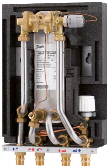
Der Durchflusswassererwärmer Akva Lux II für große Leistungen und höchsten Bedienungskomfort eignet sich besonders für die Trinkwasser-Erwärmung in Einfamilienhäusern und Etagenwohnungen von Mehrfamilienhäusern. Das Trinkwasser wird im Wärmeübertrager nach dem Durchflussprinzip erwärmt. Dabei sorgt der PTC2+P-Regler von Danfoss für eine zuverlässige und komfortable hydraulische Regelung der Warmwasserversorgung.
