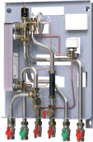
Die EvoFlat™ Reno ist eine Wohnungsstation für die direkte Beheizung einer Wohnung und die bedarfsgerechte dezentrale Trinkwassererwärmung im Durchfluss. Diese Stationen eignen sich besonders für den Austausch alter Gasthermen in Wohnungen von Mehrfamilienhäusern.
