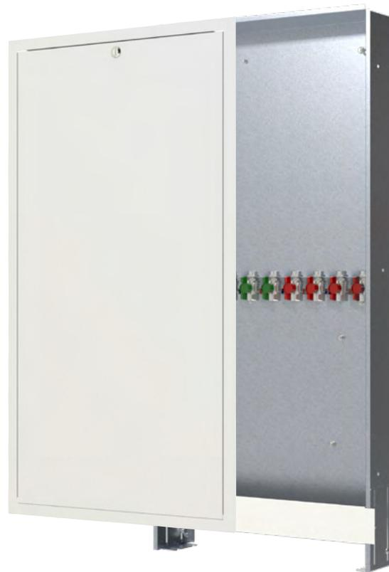
Unterputzgehäuse aus verzinktem Stahlblech in stabiler Ausführung. Das Gehäuse ist umseitig geschlossen, unten offen. Einbaumöglichkeit in ein Mauerwerk oder in einer Trockenbauwand. Montageschiene einschl. Kugelhähne im Gehäuse bereits integriert. Geeignet für die Montage von Danfoss-Trinkwassererwärmer\* und Wohnungsstationen. Sichtteil mit Rahmen in formschönem Design. Abnehmbar und aus verzinktem Stahlblech, pulverbeschichtet weiß (RAL 9016).
