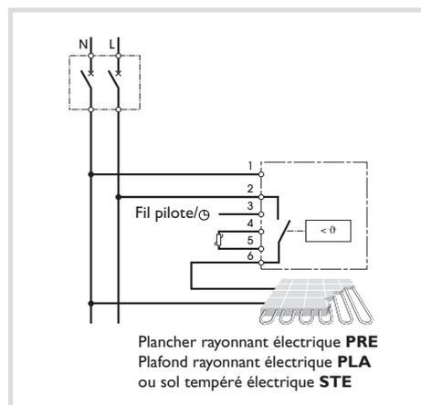
Type de capteur: 084N3210 NTC 10kohms 3,5m
