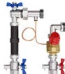
**AB-PM Anschluss-Set, kompaktes, platzsparendes differenzdruckregelndes Anschluss-Set für Fußbodenheizungsverteiler inkl. Absperrungen, Verschraubungen, Wärmemengenzähler-Passstück, Impulsleitung, notwendige Adapter. Der im Anschluss-Set integrierte Differenzdruckregler mit Volumenstrombegrenzung AB-PM garantiert den automatischen Abgleich aller Fußbodenheizungsverteiler im Netz, speziell bei Teillast. Kombinierbar mit allen üblichen Verteilerfabrikaten, Medientemperatur -10 bis 120 °C, PN 16**
