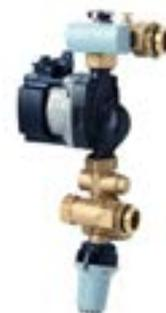
**Kompakt-Mischerguppe FHM für Fußbodenheizung, mit Umwälzpumpe, Konstanttemperaturregelung durch selbsttätigen Regler, Thermometer 0 - 60 °C im Vorlauf, Entlüftungsventil manuell, Rückflussverhinderer, Anschluss Primärseite ½", Anschluss Sekundärseite 1", für die Montage im Verteilerschrank geeignet. Anmerkung: Passender Verteiler / Halter: siehe Danfoss Verteiler, Messing siehe Seiten 114 und 116**
