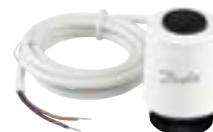
**Thermischer Stellantrieb für weitere Fabrikate mit Anschluss M30 x 1,5 AG (z.B. Heimeier, Oventrop und MNG Standardventile), mit Stellungsanzeige (kein Adapter erforderlich), ohne Handverstellung, max. Umgebungstemperatur 50 °C, Leistungsaufnahme 2 Watt, andere Hersteller auf Anfrage**
