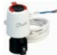
**Thermischer Stellantrieb für Danfoss Verteiler FHF und SSM, mit Stellungsanzeige, ohne Handverstellung, max. Umgebungstemperatur 50 °C, Leistungsaufnahme 2 Watt**
