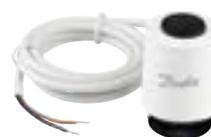
**Thermischer Stellantrieb für weitere Fabrikate mit Anschluss M30 x 1,5 AG (z.B. Heimeier, Oventrop und MNG Standardventile), mit Stellungsanzeige (kein Adapter erforderlich), ohne Handverstellung, max. Umgebungstemperatur 50 °C, Leistungsaufnahme 2 Watt, andere Hersteller auf Anfrage**
