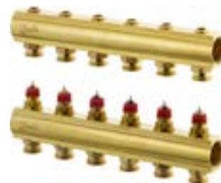
**Fußbodenheizungsverteiler mit Durchflussanzeige aus Messing, mit integrierten, voreinstellbaren Danfoss-Ventileinsätzen im Rücklauf, Abstand 50 mm, mit Durchflussanzeige im Vorlauf, absperrbar und voreinstellbar, zur Aufnahme von thermischen Stellantrieben TWA-A im Rücklauf, Heizkreisanschlüsse 3/4" AG, PN 6**
