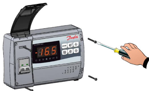
Obr. 2 Uvolněte 4 připevňovací šrouby z čela skříňky.
