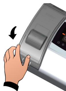
Obr.3 Vraťte zpět průhlednou ochranu proudového chrániče.
