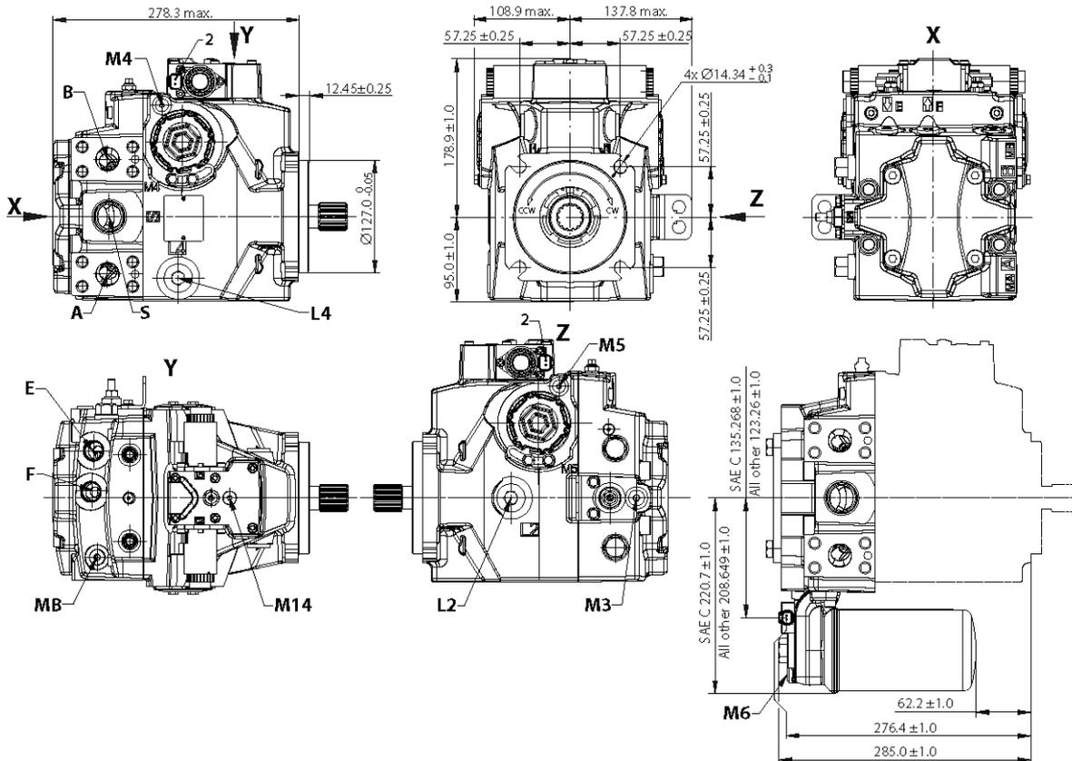
Ports du système A/B : Ø 25,4 – 450 bars, bossage de bride fendue ISO 6162 ; M1 2x 1,75, profondeur totale de filetage min. 20 mm
