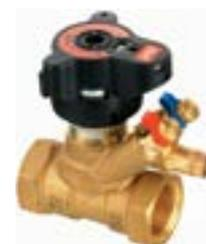
Strangregulier- und Messventil Typ ASV-BD zur Kombination mit Strangdifferenzdruckregler, mit Anschlussmöglichkeit für die Impulsleitung, präzise Feineinstellung mit digitaler Skala, Messung und Entleerung von Vor- und Rücklauf über eine drehbare Serviceeinheit, integrierter Kugelhahn mit Stellungsanzeige zur Absperrung, Medientemperatur -20 bis 120 °C, inkl. schwarzer EPP-Isolierschale bis 120 °C, PN 16
