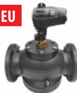
**Druckunabhängiges Regelventil Typ AB-QM Novocon® DN 40 - 100**, zur Regelung und hydraulischem Abgleich in Kombination mit dem Hochgenauigkeits-Stellantrieb NovoCon® M, Medientemperatur -10 bis 120 °C, Ausführung mit 3 Messnippeln, PN 16, Ventilanschluss: DN 40/50 Außengewinde(nach ISO228/1), DN 50-100 Flansch (nach DIN EN 1092-2)
