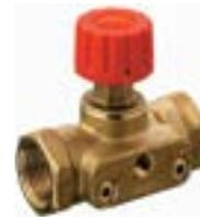
Strangabsperrr- und Messventil Typ ASV-M zur Kombination mit Strangdifferenzdruckregler, Anschlussmöglichkeit für die Impulsleitung und Messnippel mit rotem Handrad; max. Differenzdruck über dem Ventil 1,5 bar, max. Wassertemperatur 120 °C, inkl. grauer Isolierschale bis 80 °C, PN 16
