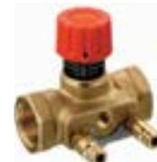
Strangregulier- und Messventil Typ ASV-I zur Kombination mit Strangdifferenzdruckregler, einschließlich 2 Messanschlüssen und Anschlussmöglichkeit für die Impulsleitung, Absperrung mit rotem Handrad, max. Differenzdruck über dem Ventil 1,5 bar, max. Wassertemperatur 120 °C, inkl. grauer Isolierschale bis 80 °C, PN 16
