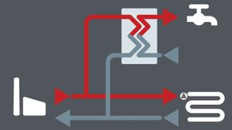
Wohnungsstation für direkte Beheizung mit integriertem Frischwassersystem zur Trinkwassererwärmung im Durchfluss für Wohnungen mit Fußbodenheizung in Mehrfamilienhäuser.
