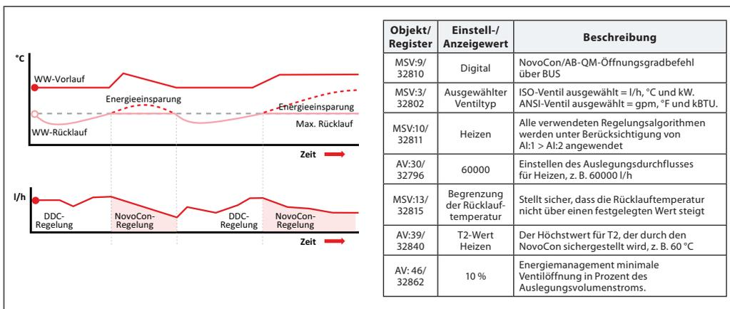
**Zustand 7: Eingestellte Rücklauftemperatur-Regelung (Beispiel Heizwasser)**
