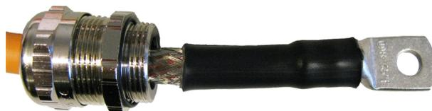
8. Das Kabel durch die entsprechende Öffnung im Rahmen des elektrischen Geräts führen und den Kabelschuh mithilfe einer passenden Schraube mit der Leistungsklemme verbinden. Verwenden Sie eine Federscheibe zwischen Kabelschuh und Anschlussschraube oder -mutter. Die Kabelschuhschraube noch nicht festziehen, um das Anbringen der Kabelverschraubung zu ermöglichen.
