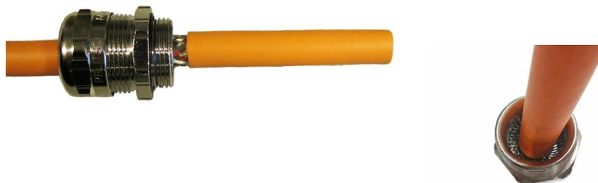
4. Wenn die Kabelverschraubung montiert ist, entfernen Sie das Schirmstück mit Länge A und schneiden Sie den Geflechschirm (Abdeckung) 10 mm (Abstand C) vom unteren Ende der Verschraubung, wie in der Abbildung dargestellt.
