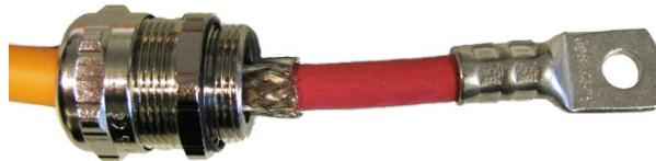
7. Schneiden Sie ein Stück Schrumpfschlauch ab und schrumpfen Sie es über dem Kabelschuh und dem Geflechtschirm, wie in der nachfolgenden Abbildung dargestellt. Dies dient dazu, den Geflechtschirm zu fixieren und für zusätzliche Isolierung zu sorgen.
