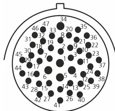
**Deutsch HD34-24-47PE 连接器的引脚定义**
