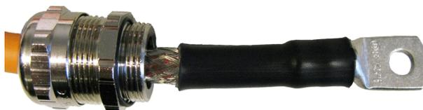
8. 通过接线盒中的对应孔插入电缆并将电缆接线头连接到连接点。在电缆接线头和连接螺钉或螺母之间使用弹簧垫圈。连接示例如下图所示。此时请勿拧紧接头，以确保装上电缆接线头。
