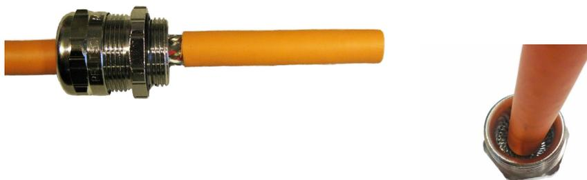
4. 将电缆密封接头推入到位后，去除 A 段护套，然后从距离密封接头底部 10 毫米（距离 C）处切割编织网（罩盖），如下图所示。
