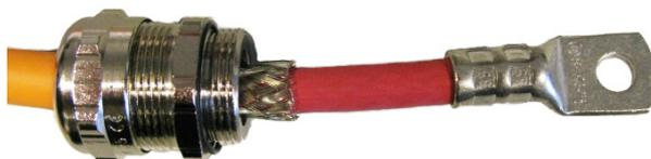
7. 切割一段收缩管，将它套在电缆接线头和编织网上进行收缩，如下图所示。这样做是为了将编织网固定到位并提高绝缘性。
