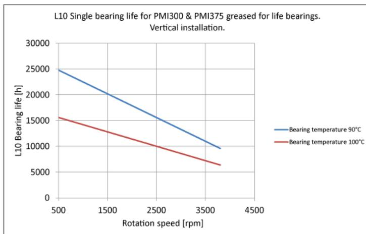
轴承润滑油使用寿命信息中的  $L_{10}$  表达式是表示使用寿命的标准方式，意味着在该使用寿命到期时，有 90% 的轴承仍能可靠润滑和工作。
