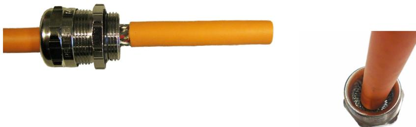
4. Wenn die Kabelverschraubung montiert ist, entfernen Sie das Schirmstück mit Länge A und schneiden Sie den Geflechtschirm (Abdeckung) 10 mm (Abstand C) vom unteren Ende der Verschraubung, wie in der Abbildung dargestellt.
