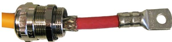
7. Schneiden Sie ein Stück Schrumpfschlauch ab und schrumpfen Sie es über dem Kabelschuh und dem Geflechschirm, wie in der nachfolgenden Abbildung dargestellt. Dies dient dazu, den Geflechschirm zu fixieren und für zusätzliche Isolierung zu sorgen.
