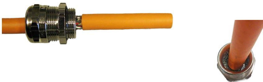
4. Wenn die Kabelverschraubung montiert ist, entfernen Sie das Schirmstück mit Länge A und schneiden Sie den Geflechtschirm (Abdeckung) 10 mm (Abstand C) vom unteren Ende der Verschraubung, wie in der Abbildung dargestellt.
