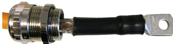
8. Insira o cabo no furo correspondente na estrutura do dispositivo elétrico e conecte o terminal do cabo ao terminal de alimentação com o parafuso correto. Use uma anilha de mola entre o terminal do cabo e o parafuso de ligação ou porca. Não aperte o parafuso do terminal do cabo nesta altura para assegurar o ajuste do buçim.
