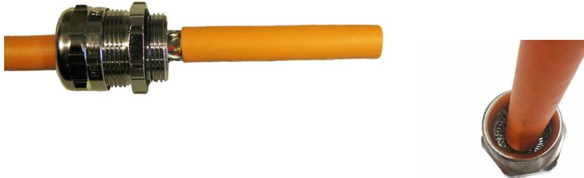
4. Após o buçim estar no lugar remova a parte da bainha de comprimento A e corte a blindagem entrançada (cobertura) de 10 mm (distância C) da base do buçim, como mostrado na Figura abaixo.
