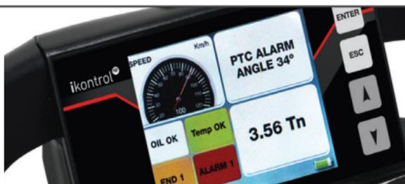
全二重通信が可能。新しい Ikugraph ソフトウェアを使用すると、ディスプレイに表示されるフィードバック画面をカスタマイズできます。
