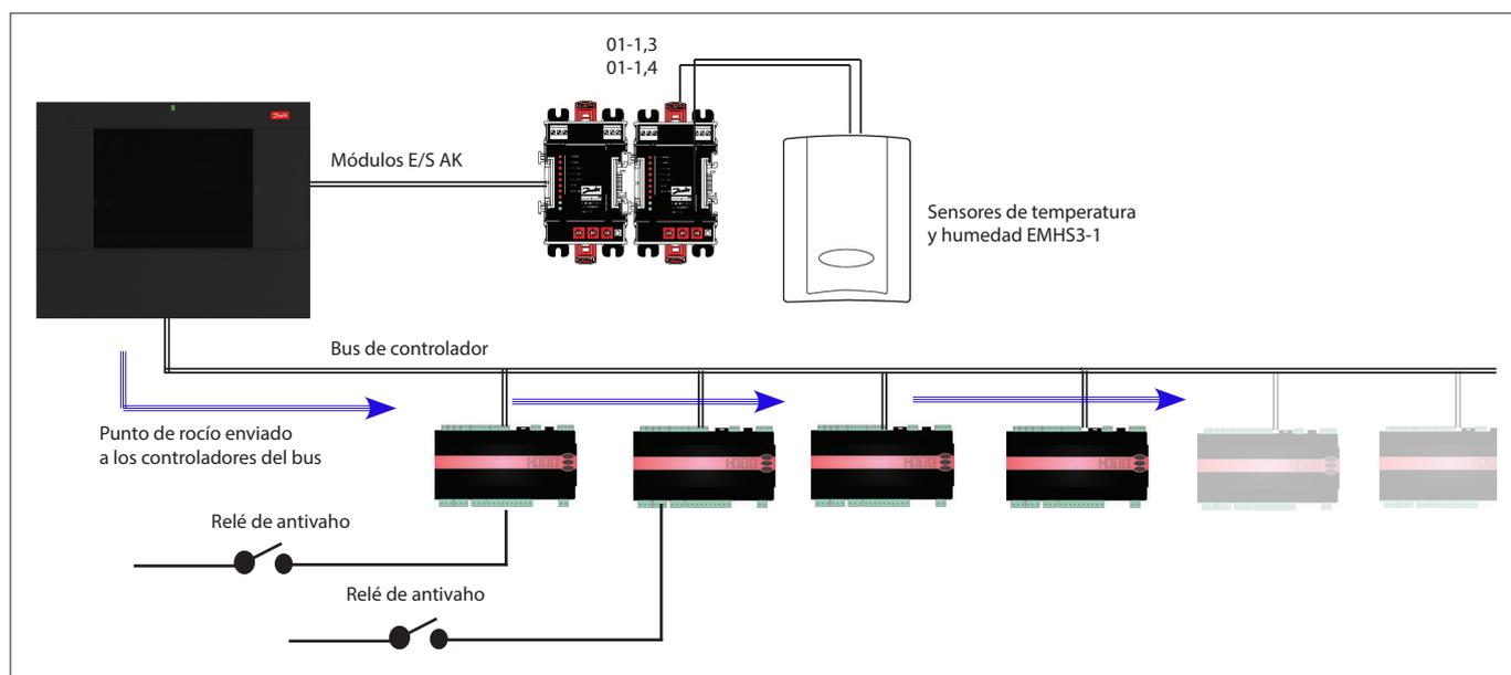
Para que el antivaho adaptativo funcione correctamente, asegúrese de que los controladores del AK-CC 550 cuenten con la configuración correcta. Revise los parámetros o85, o86 y o87, como se indica a continuación. La siguiente captura de pantalla señala el controlador del AK-CC 550 (menú Varios), donde se configuran los parámetros o85, o86 y o87 para el control del antivaho mediante el bus.
