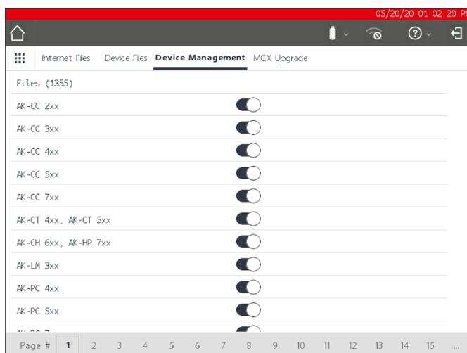
Asegúrese de desactivar siempre todos los grupos de dispositivos que no estén en uso. Al realizar un nuevo escaneo, los grupos de dispositivos se activarán automáticamente en caso de detectarse algún dispositivo dentro de los grupos.
