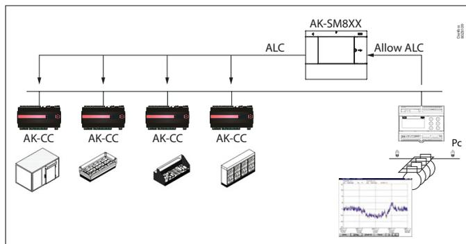
Para habilitar el control automático CALM en el administrador de sistemas de la serie AK-SM 800A, el controlador de la tral c deberá ser capaz de determinar cuándo se permite el s.centralc deberá ser capaz de determinar cuándo se permite el s. De forma similar, los controladores de evaporadores deben poder funcionar en modo CALM. Consulte a su representante local de ventas para obtener más información sobre los controladores de evaporadores y de central compatibles.
