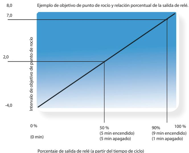
**Método adaptativo (con controladores del evaporador compatibles de Danfoss)**
