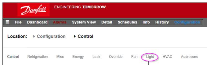
La configuración detallada se realiza en la pestaña Luz (Configuración → Control → Luces).
