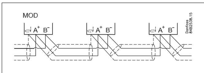
Asegúrese de configurar el repetidor MODBUS AKA222 (código n.º 084B2240) con la velocidad de transferencia de datos adecuada. Consulte la sección de notas, al dorso de este manual, para obtener información sobre la velocidad de transferencia de datos del dispositivo MODBUS. Para ver más detalles sobre el repetidor AKA 222, consulte las instrucciones RI8KN402 de Danfoss.
