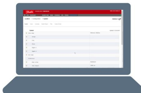
SvB5 es un módulo de software que utiliza HTML 5, incluido en el paquete de software AK-SM 800A, cuya versión se puede ver en las pantallas de información de su AK-SM 800A. Para facilitar el uso, no se necesitan herramientas ni configuraciones especiales. Solo tiene que abrir un navegador compatible y escribir la dirección HTTPS de su unidad AK-SM 800A, por ejemplo, HTTPS://192.168.1.50.
