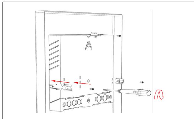
Retire la cubierta del técnico
