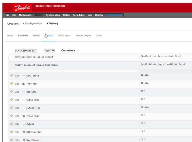
Naviguez et sélectionnez les points adaptés pour l'enregistrement de l'historique, par le sélecteur du menu déroulant. Double-cliquez sur la ligne souhaitée, une fenêtre de sélection contextuelle permet de choisir la fréquence d'échantillonnage :
