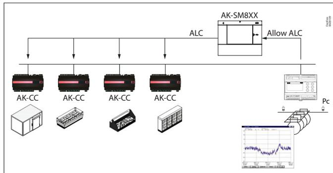
Pour activer la régulation CALM automatique dans le gestionnaire de système AK-SM 800A, le régulateur de centrale frigorifique doit être capable de déterminer quand autoriser la régulation du liquide. De même, les régulateurs de vitrines doivent pouvoir fonctionner en mode CALM. Veuillez consulter votre représentant local pour plus de détails sur les régulateurs de vitrines et de centrales pris en charge.
