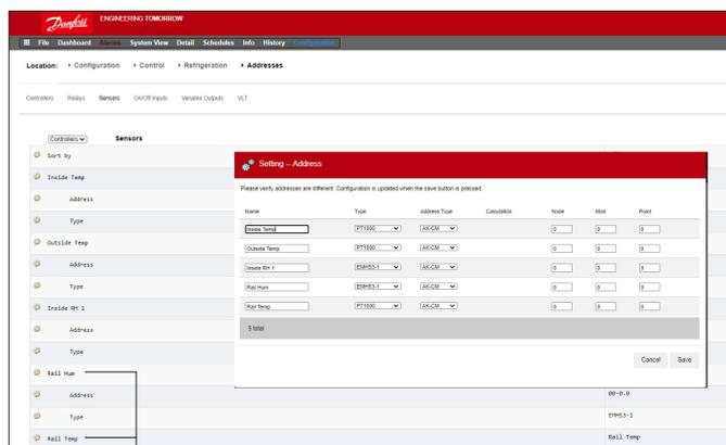
Quand la sonde EMHS3-1 est utilisée, les sorties humidité et température sont connectées aux E/S AK-XM. Utilisez l'onglet « Adresses » pour localiser le sous-onglet Sonde qui permet de régler le module et les points appropriés (en phase avec les connexions effectives sur l'E/S AK-XM).
