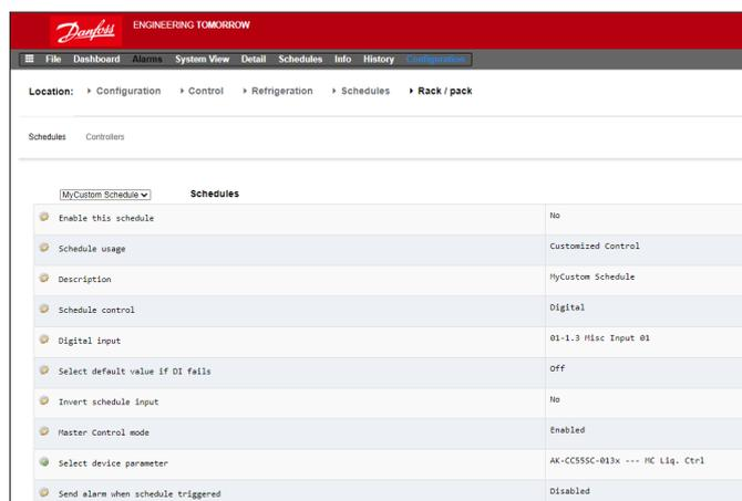
Dans l'onglet correspondant appelé « Régulateurs », il est possible de sélectionner les régulateurs qui contiennent le paramètre d'appareil activé/désactivé choisi. Désélectionnez les régulateurs qui ne doivent pas être inclus dans la régulation personnalisée.
