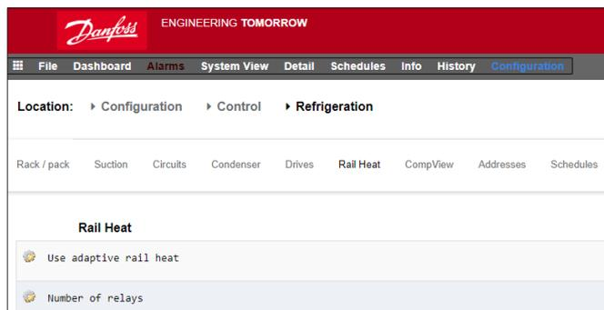
À partir de l'écran Régulation, accédez à Réfrigération, puis à Rail antibuée (Configuration → Réfrigération → Rail Heat).
