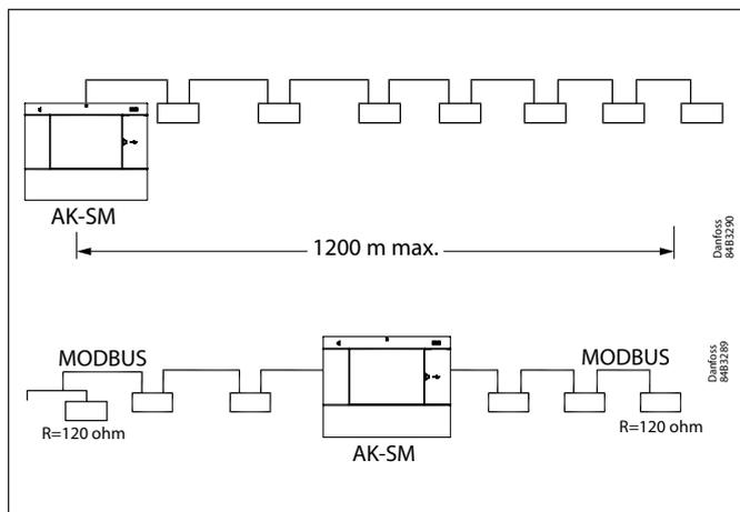
Les fils sont bouclés de régulateur à régulateur.
