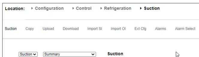
**Remarque :** La fonction «copier» copie les paramètres d'un régulateur, par exemple, depuis un régulateur vers la base de données AK-SM. Pour terminer l'opération, les réglages (copiés) doivent être transférés vers les régulateurs voulus.
