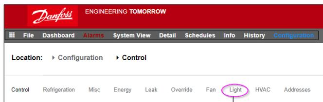
La configuration détaillée est effectuée dans l'onglet Light (Éclairage) (Configuration → Control → Light).
