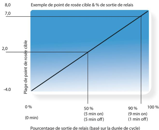
**Méthode adaptative (avec régulateurs d'évaporateurs Danfoss compatibles)**
