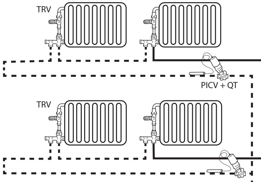
Pri tej aplikaciji zagotavljamo avtomatsko omejevanje pretoka za vse ogrevalne zanke in omejujemo temperaturo povratka s termostatskim tipalom (QT), da se izognemo nizki  $\Delta T$  v zankah med delno obremenitvijo. (Bolj učinkovito v primeru nižje zunanje temperature.)
