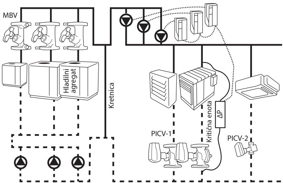
Ta sistem je različica konstantnega primarnega sistema (s konstantnim pretokom\*). Za regulacijo črpalk na sekundarni strani se uporabijo pogoni s spremenljivo hitrostjo. Z ločevanjem primarnega in sekundarnega tokokroga je možno hladilne agregate vklapljati po stopnjah glede na spremjanje obremenitve ter hkrati ohraniti konstanten pretok\* na hladilnih agregatih. (Za opis sekundarne strani glejte aplikacije: 1.1.1.1–1.1.1.3)
