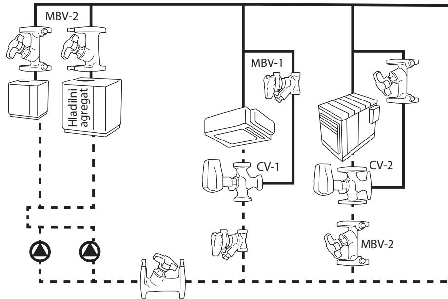
Ta aplikacija je ena najstarejših aplikacij hladilnih agregatov brez pogonov s spremenljivo hitrostjo za črpalke in hladilne aggregate. Hladilni agregati prenesejo samo stalne pretoke, zato so za ohranjanje konstantnega pretoka\* na sekundarni strani sistema nameščeni 3-potni regulacijski ventili. Ti regulirajo pretok skozi končne enote, da se ohrani konstantna temperatura prostora. (Za opis sekundarne strani glejte aplikacije: 1.1.2.1, 2.2 in 3.2.1)
