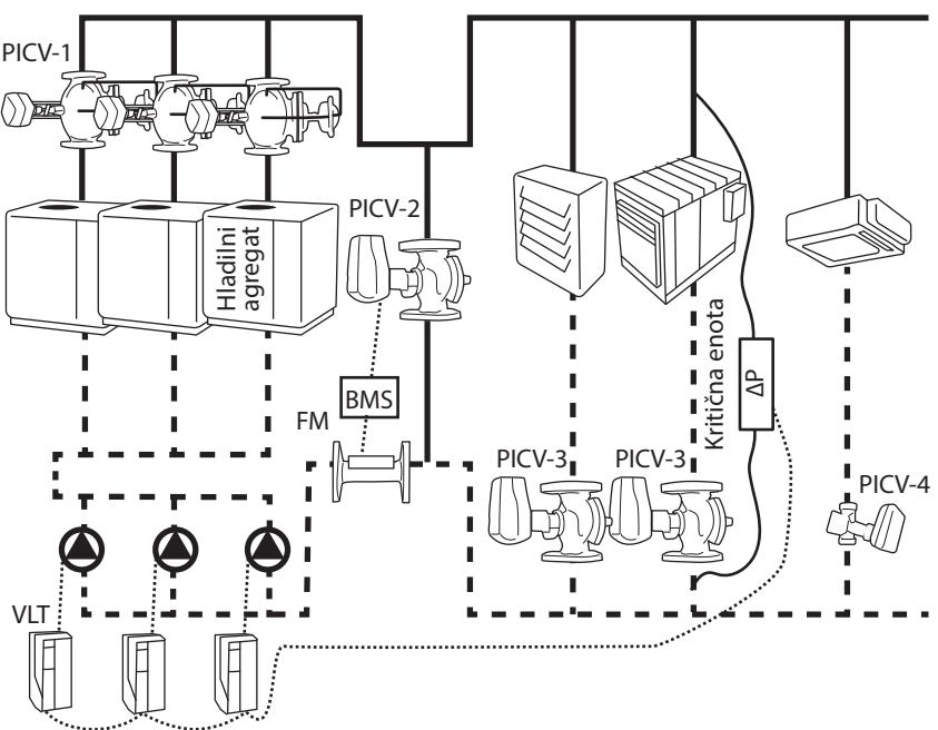
Pri sistemu s spremenljivim pretokom\* je ta aplikacija najučinkovitejši sistem za termično delovanje stavbe. Hladilni agregati imajo lahko več kompresorjev s spremenljivo hitrostjo.
