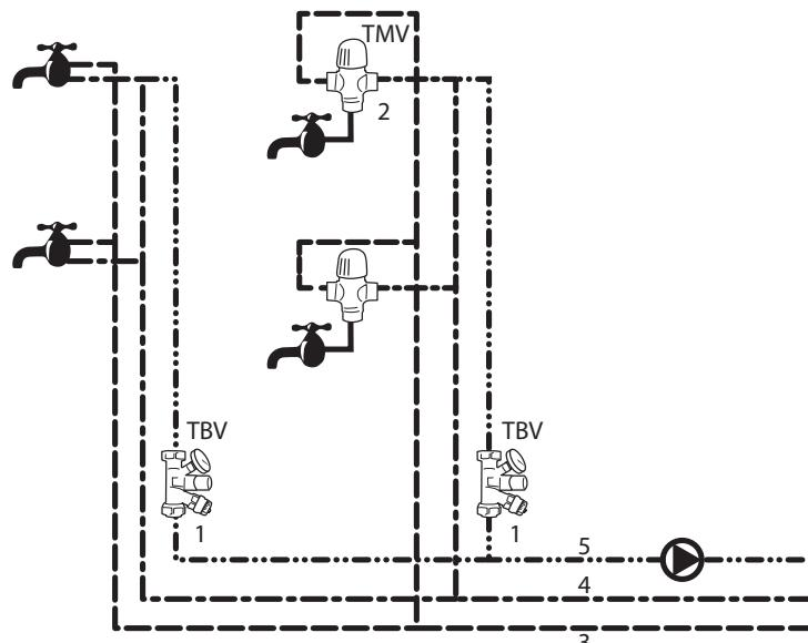
Pri tej aplikaciji zagotavljamo spremenljivi pretok\* v cevovodu za cirkulacijo sanitarne tople vode\* in konstantno temperaturo vode iz pipe\* na vsaki pipi, neodvisno od oddaljenosti od rezervoarja ter trenutne uporabe tople vode. S tem zmanjšamo količino obtočne vode v vseh obdobjih. Samodejna topotna dezinfekcija je mogoča s pomočjo posebnega modula v ventilih MTCV. Termostatski mešalni ventil (izbirni) zagotavlja maksimalno temperaturo vode iz pipe in preprečuje možnost opeklín.
