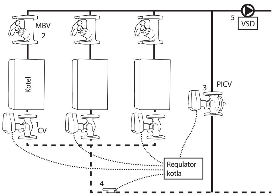
Ta aplikacija se uporablja za tradicionalne (nekondenzacijske) kotle. Da se izognemo nizki vhodni temperaturi v kotle, je potrebna regulacija obvoda (s tlačno neodvisnim regulacijskim ventilom). Pri tej aplikaciji za pogovanje pretoka skozi primarni in sekundarni sistem uporabljamo samo en sklop črpalk.
