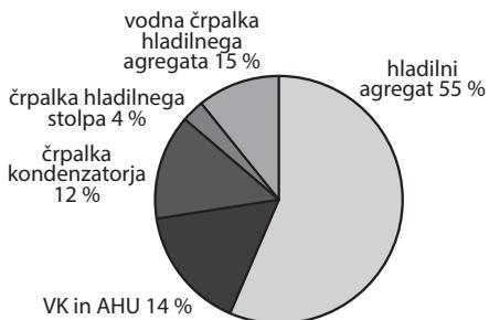
Poraba energije hladilnega agregata predstavlja 55 % porabe energije celotnega hladilnega sistema. Kot referenco vzemimo porabo energije za hladilni agregat 390 MWh. Celotni sistem torej na sezono porabi 710 MWh električne energije.
