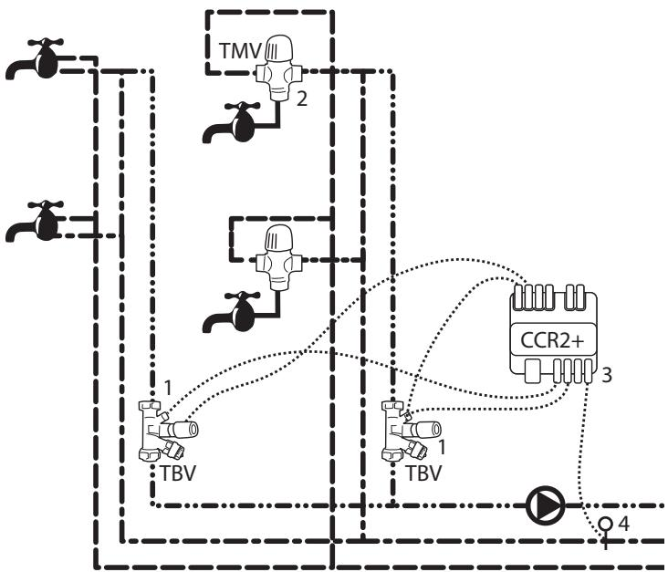
Pri tej aplikaciji zagotavljamo spremenljivi pretok\* v cevovodu za cirkulacijo sanitarne tople vode\* in konstantno temperaturo vode iz pipe\* na vsaki pipi, neodvisno od oddaljenosti od rezervoarja ter trenutne uporabe tople vode. S tem zmanjšamo količino obtočne vode v vseh obdobjih. Termostatski mešalni ventili (TMV) zagotovijo konstantno temperature vode iz pipe\* tudi v obdobju toplotne dezinfekcije. Toplotno dezinfekcijo\* regulira elektronska naprava CCR2+.
