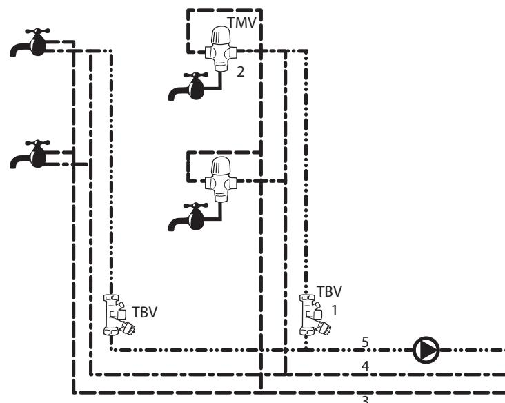
Pri tej aplikaciji zagotavljamo spremenljivi pretok\* v cevovodu za cirkulacijo sanitarne tople vode\* in konstantno temperaturo vode iz pipe\* na vsaki pipi, neodvisno od oddaljenosti od rezervoarja ter trenutne uporabe tople vode. S tem zmanjšamo količino obtočne vode v vseh obdobjih. Toplotna dezinfekcija\* je mogoča z dodatno opremo. Termostatski mešalni ventil (izbirni) zagotavlja maksimalno temperaturo vode iz pipe in preprečuje nalaganje vodnega kamna.
