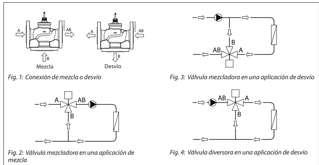
Fig. 1: Conexión de mezcla o desvío
