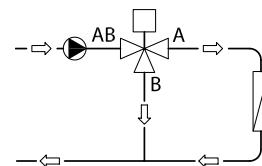
Фиг. 4: Отклоняващ вентил, използван в отклоняващо приложение
