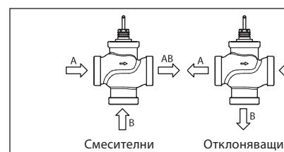
Фиг. 1: Съврзване за смесване или отклоняване
